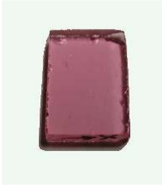
Figura 3.23 - Quartzo rosa sintético dopado com fósforo [42] .
