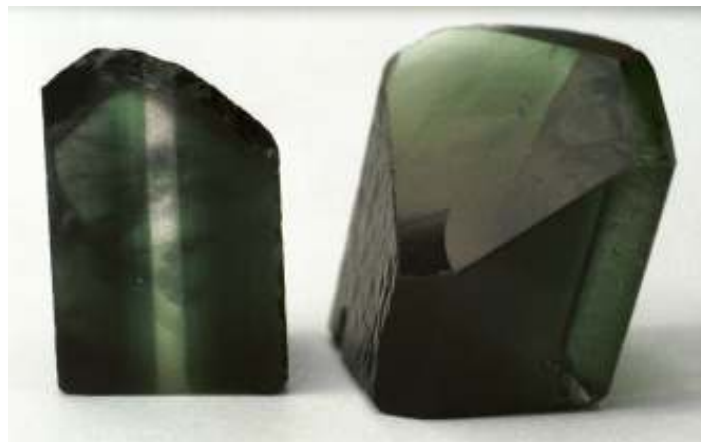
Figura 3.21 - Quartzo verde dopado com ferro [59] .
