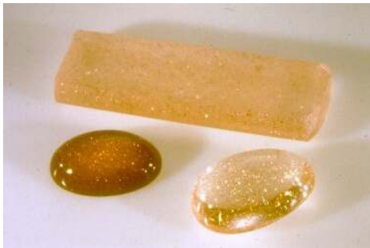
Figura 3.26 - Quartzo rosa-dourado dopado com cobre [42] .
