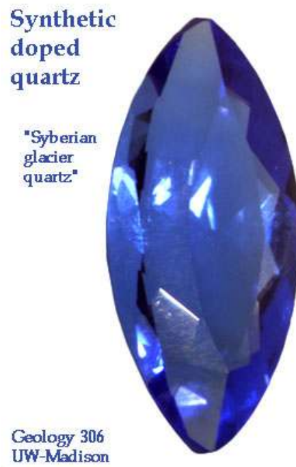
Figura 3.30 - Quartzo sintético azul dopado com cobalto [69] .
