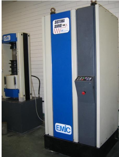
Figura 4-13 - Prensa servo-hidráulica laboratório de construção civil, ensaios CEFET-ES.
