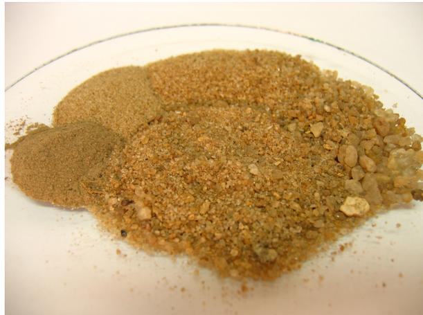
Figura 4-5 - Agregado miúdo, ensaios CEFET-ES.
