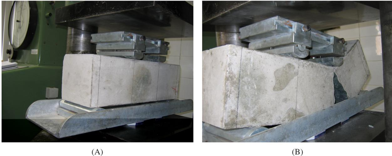
Figura 4-14 - (A) Arranjo para o ensaio de tração na flexão, ensaios HOLCIM. (B) Corpo-de-prova rompido, ensaios HOLCIM.
