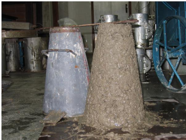
Figura 5-11 - Ensaio de abatimento do tronco de cone NS-2, ensaios CEFET-ES.
