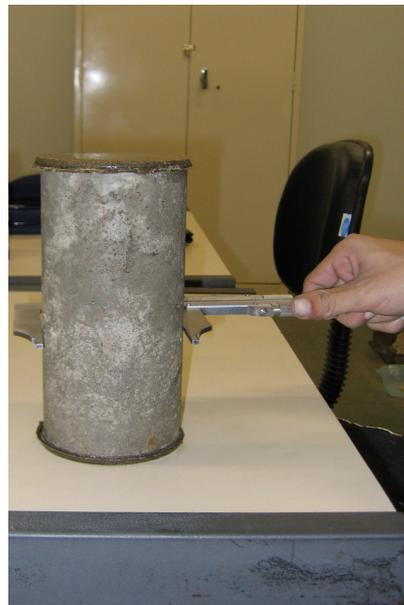
Figura 4-12 - Determinação das dimensões do corpo de prova, ensaios CEFET-ES.
