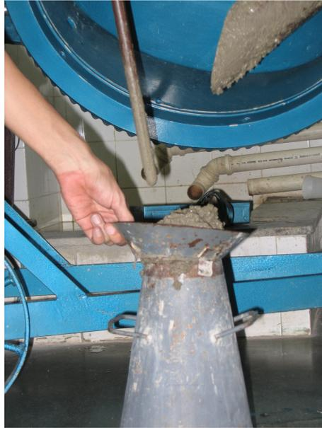
Figura 4-11 - Execução de Slump-test, ensaios CEFET-ES.
