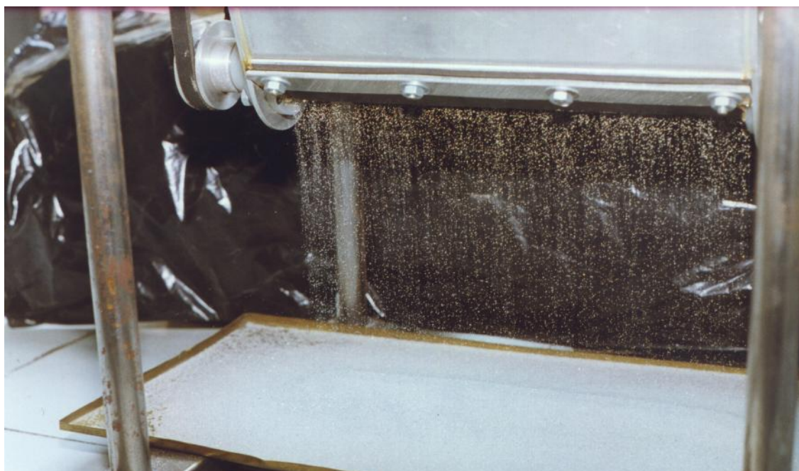
FIGURA 3.16. – Distribuição das microesferas de vidro
