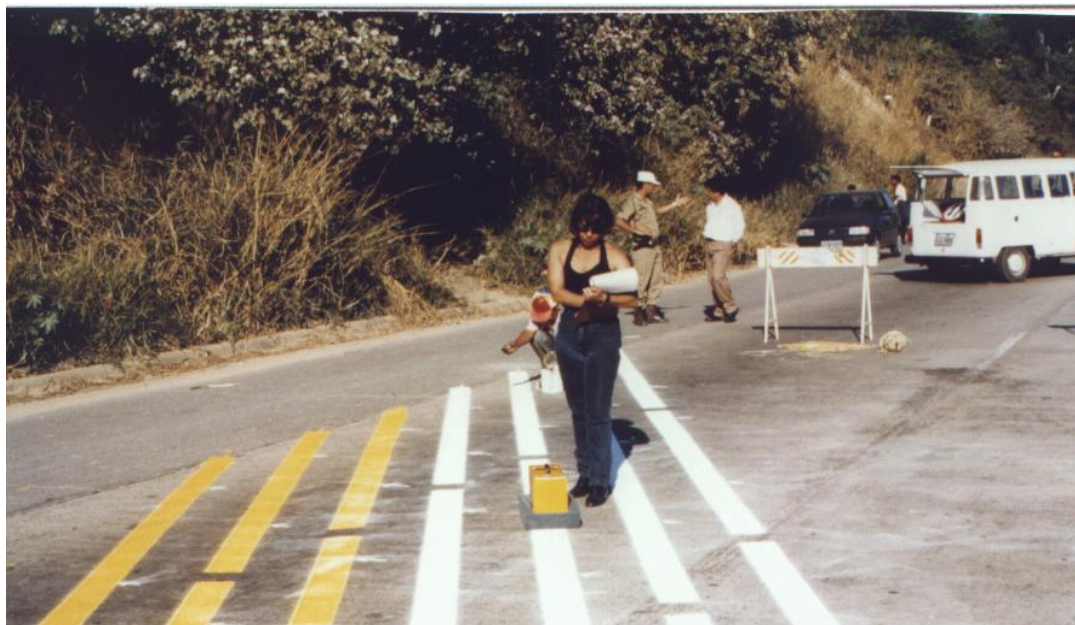
FIGURA 3.9. – Medição de retrorefletância.
