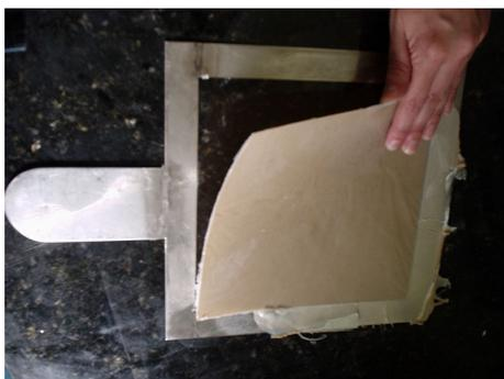
**Figura 24:** Desmoldagem da lâmina fabricada por termoprensagem.
