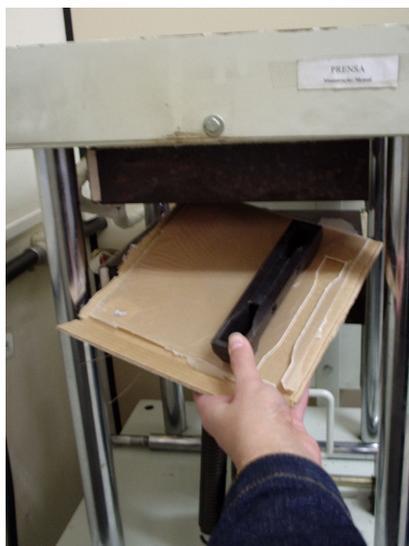
**Figura 27:** O molde foi posicionado na superfície da lâmina para o recorte dos corpos de prova
