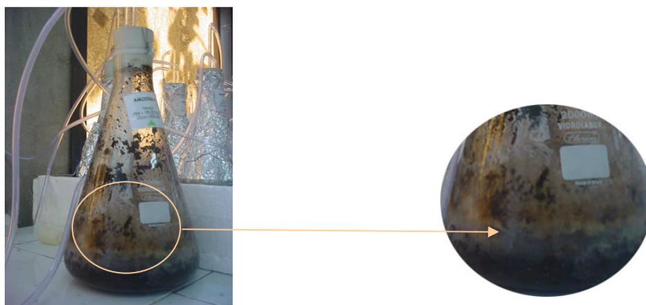
**Figura 52:** Fotografia do Biorreator após o final do ensaio de biodegradação.
