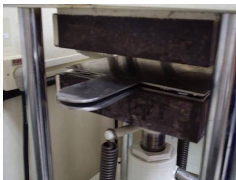
**Figura 23:** Material e moldes sob a prensa para fabricação da lâmina.
