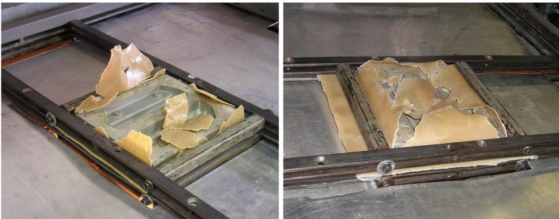
**Figura 56:** Fotografias da etapa de termomoldagem à vácuo das lâminas produzidas em laboratório com as blendas desenvolvidas.
