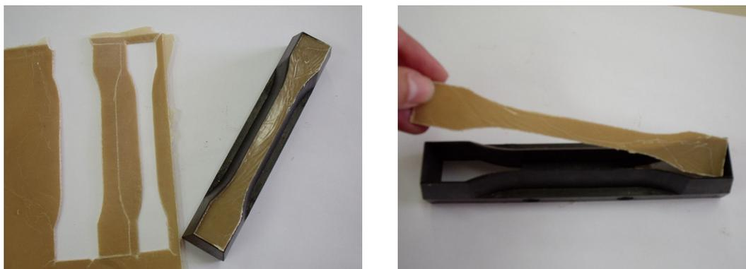
**Figura 28:** Desmoldagem do corpo de prova.
