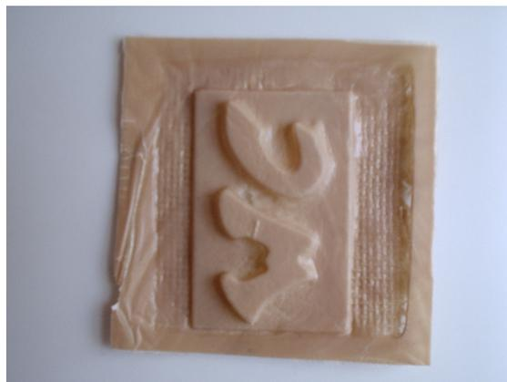
**Figura 57:** Fotografia da peça moldada em vacuum forming com blenda de composição 50% PHB 50% Ecoflex® .
