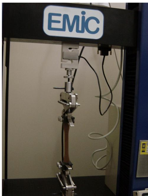
**Figura 30:** Máquina universal de testes mecânicos com corpo de prova para ensaio.
