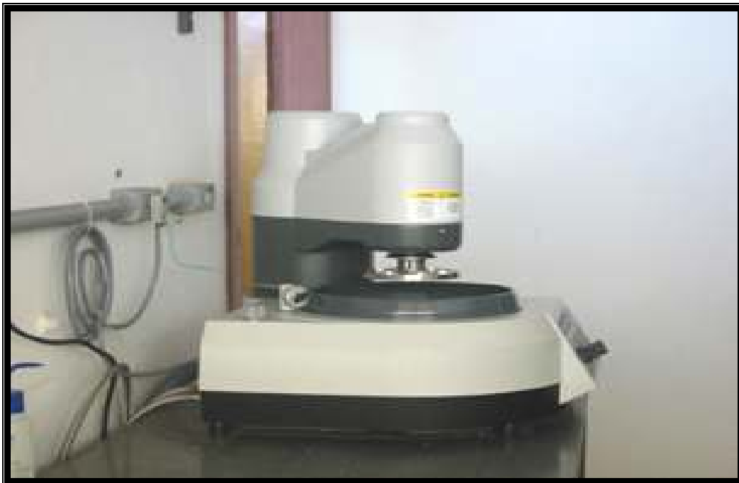
Figura. 4.2 – Fotografia da politriz automática utilizada no polimento das amostras de \text{Cr}_2\text{O}_3 .
