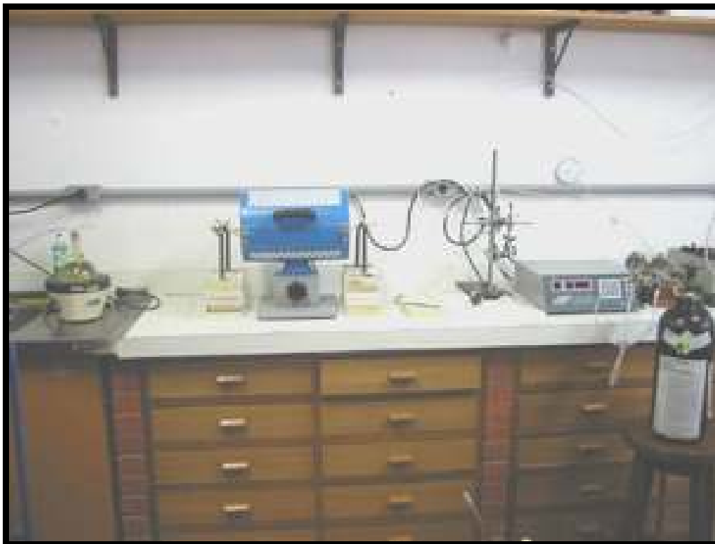
Figura. 4.4 – Montagem experimental utilizada no tratamento térmico de difusão
