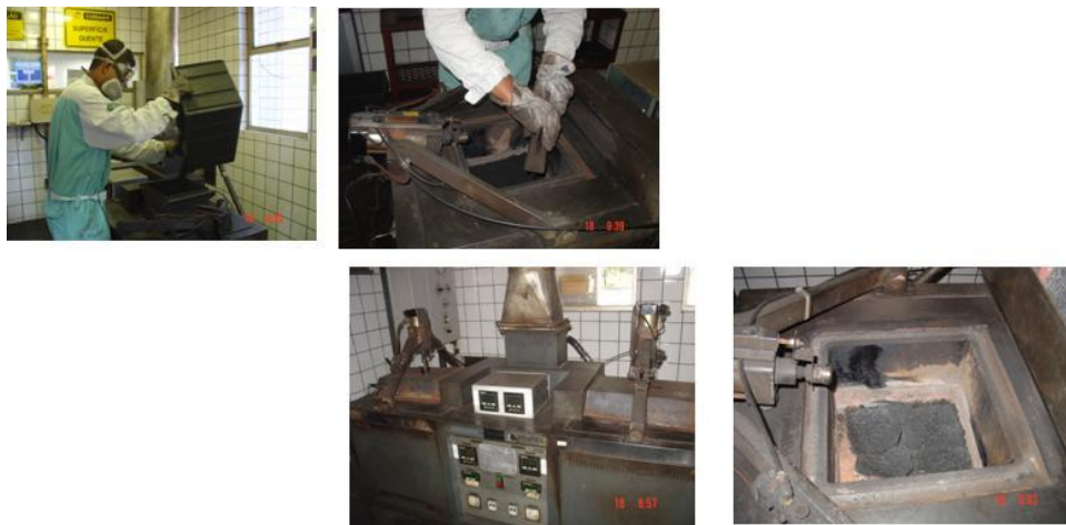
Figura 31 . Processo de enforamento e desenforamento no forno de soleira aquecida da ArcelorMittal Tubarão.
