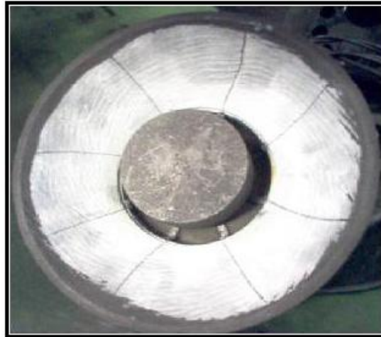
Figura 30-molde de grafite usado na produção de coroas para sondagem geológica [70]
