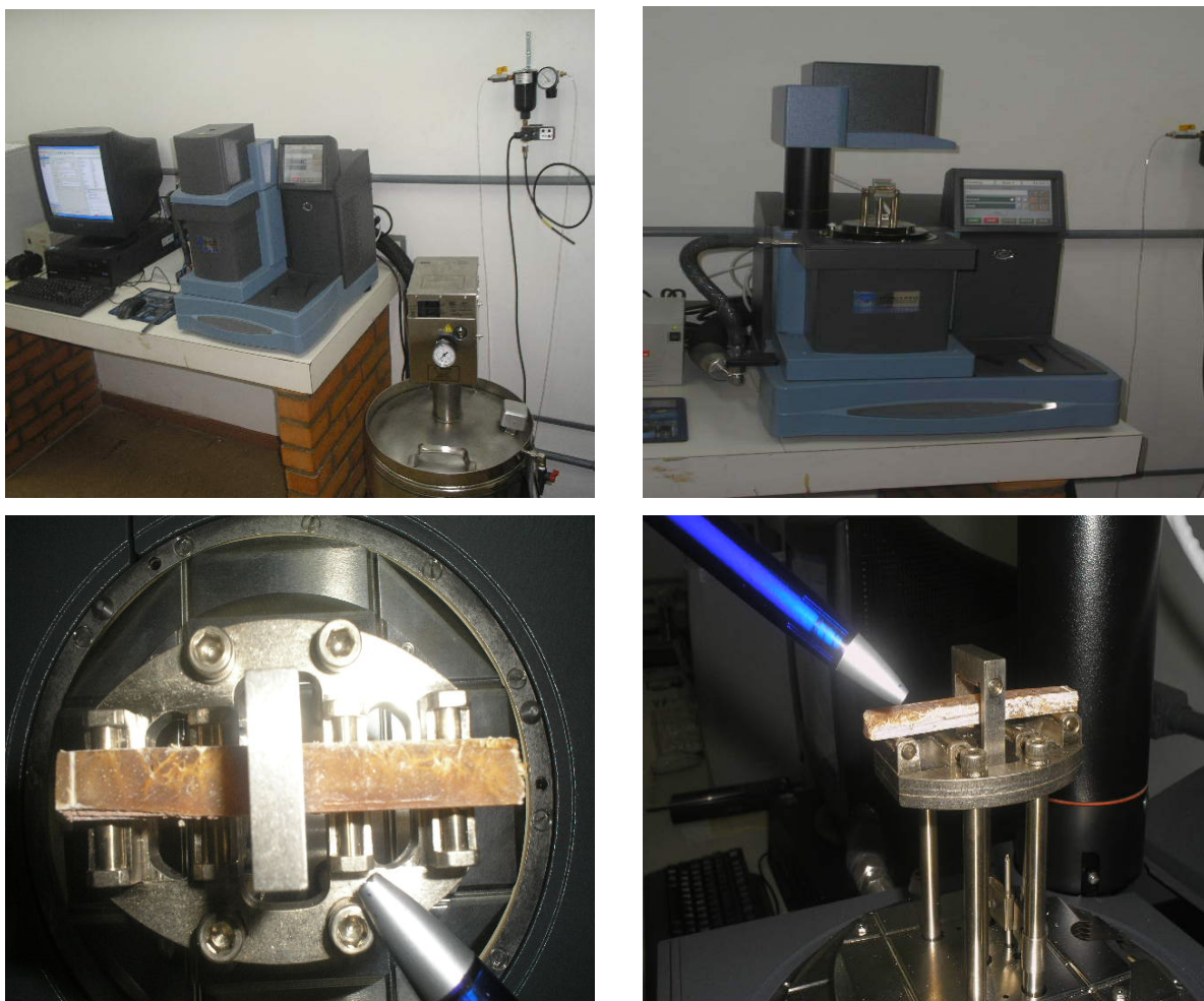
Fig. 5.25: Analisador termomecânico dinâmico Q800 da TA Instruments (Laboratório de Análises Térmicas – DEQUI / ICEB / UFOP) A) e B) DMA Q800 e C) e D) posicionamento da amostra no clamp three point bending.
