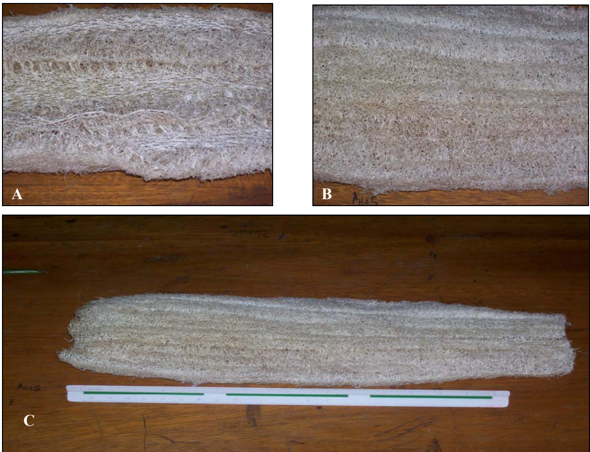
Fig. 3.14: Natureza fibrosa do fruto maduro da L. cylindrica : A) centro interno fibroso, B) centro trançado e C) manta fibrosa obtida do fruto maduro seco.
