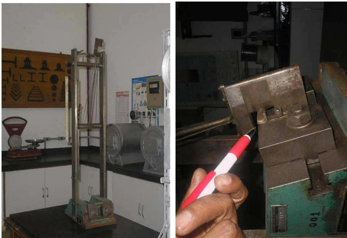
Fig. 5.43: Equipamento Alfred J. Amsler & Co. – Schoffhausen 126/176 para ensaios de impacto Charpy com entalhe do Laboratório de Ensaios Mecânicos do Departamento de Engenharia Metalúrgica – DEMET / UFOP.
