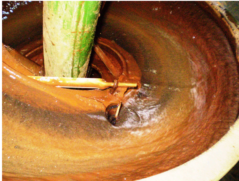
Figura 3.6 – Concentrador helicoidal Humphreys , ilustrando a segregação por espécie e por tamanho de partículas liberadas de itabirito; montagem do laboratório de tratamento de minérios do Demin/Ufop.
