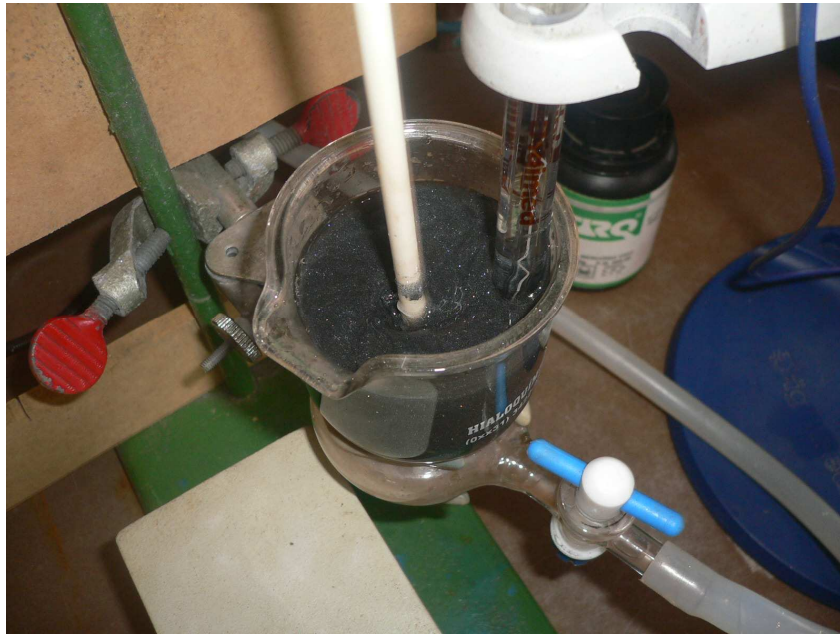
Figura 4.3 - Célula de Fuerstenau em fase de condicionamento na microflotação de hematita.
