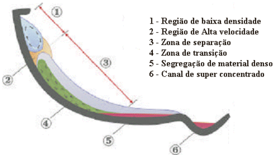
Figura 3.6 – Concentrador helicoidal Humphreys , ilustrando a segregação por espécie e por tamanho de partículas liberadas de itabirito; montagem do laboratório de tratamento de minérios do Demin/Ufop.
