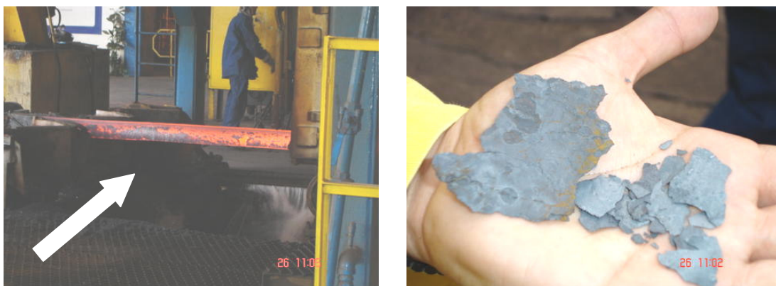
Figura 20 – Carepas na superfície e eliminadas do tarugo de aço.
