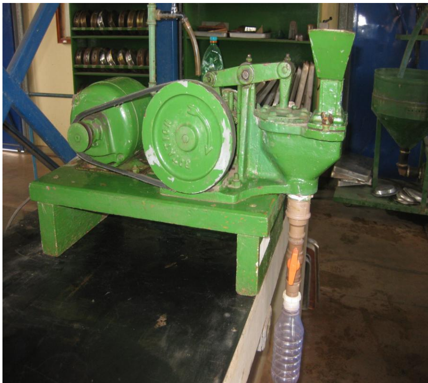
Figura 5.3.: Jigue Denver de laboratório.
