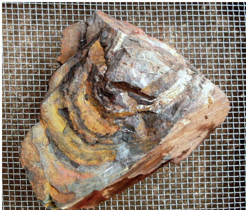
Figura 4.2. Amostra de minério de ferro de Cateruca sobre uma tela de 7 mm de abertura.
