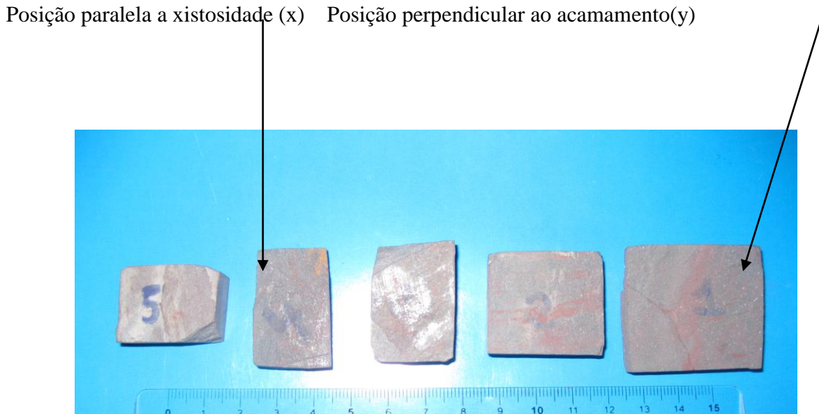
Figura 5.2: Fotografia ilustrando as posições na qual foi determinado o ensaio de determinação de dureza.
