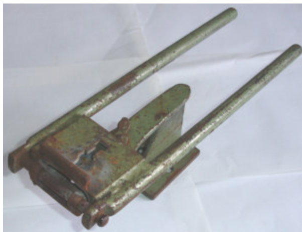
Figura 4.4 - Dispositivo para dobramento de CPs para ensaios de deformação constante no eletrodo.
