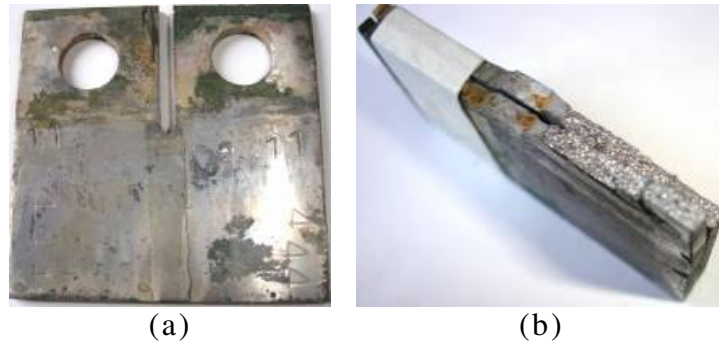
Figura 5.11 - CP do tipo tração-compacto, ensaiado sob carga constante em soluções aquosas contendo 42% MgCl_2 (143°C); (a) CP após ensaio, (b) superfície de fratura; K_I \cong 35MPa\sqrt{m} .
