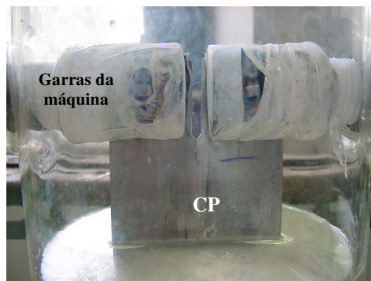
Figura 4.7 - Detalhe de um corpo-de-prova no interior da célula eletroquímica em um ensaio de carga constante no eletrodo.
