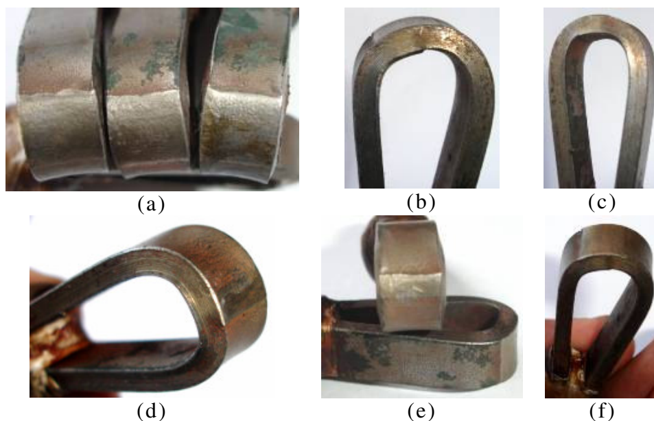
Figura 5.7 - CPs ensaiados sob tensão com deformação constante no eletrodo em MgCl_2 , pH \cong 4,0 e T \cong 143^\circ C ; sistema: AISI 444/ AISI 316LSi; (a), (b), (c) e (d) - dobramento da face da solda; (e) e (f) - dobramento na raiz da solda.
