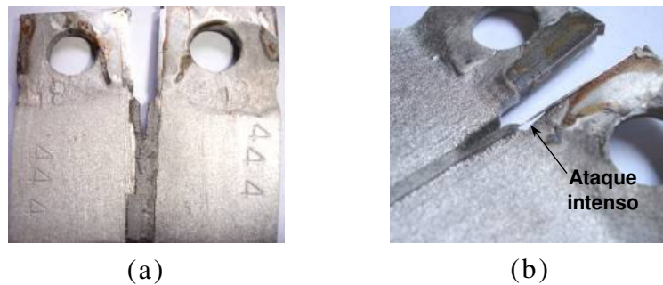
Figura 5.22 - CP ensaiado sob carga constante com polarização anódica; sistema: AISI 444/AISI 316LSi; solução aquosa contendo HCl; \text{pH} \cong 0,0 ; temperatura ambiente; (a) superfície de fratura; (b) ataque intenso na região do aço inoxidável ferrítico; K_I \cong 81\text{MPa}\sqrt{m} .
