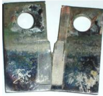
Figura 5.17 - CP tipo tração-compacto trincado por CST; carga constante; pré-trinca na região da ZTA; sistema aço AISI 444/AISI 316LSi em soluções aquosas contendo \text{MgCl}_2 ; K_I \cong 85\text{MPa}\sqrt{\text{m}} .
