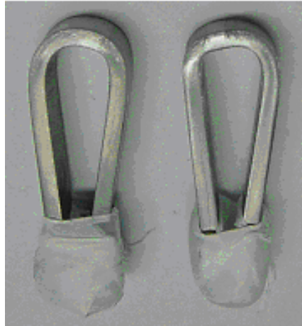
Figura 4.3 - CPs dobrados em “U” para ensaios de deformação constante no eletrodo.
