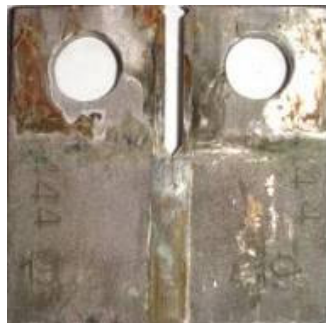
Figura 5.23 - CP ensaiado sob carga constante com polarização catódica; sistema: AISI 444/AISI 316LSi; solução aquosa contendo HCl; \text{pH} \cong 0,0 ; temperatura ambiente; K_I \cong 80\text{MPa}\sqrt{m} .
