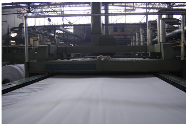
Figura 5.75 – Equipamento utilizado para polimerizar o PTFE no tecido filtrante.
