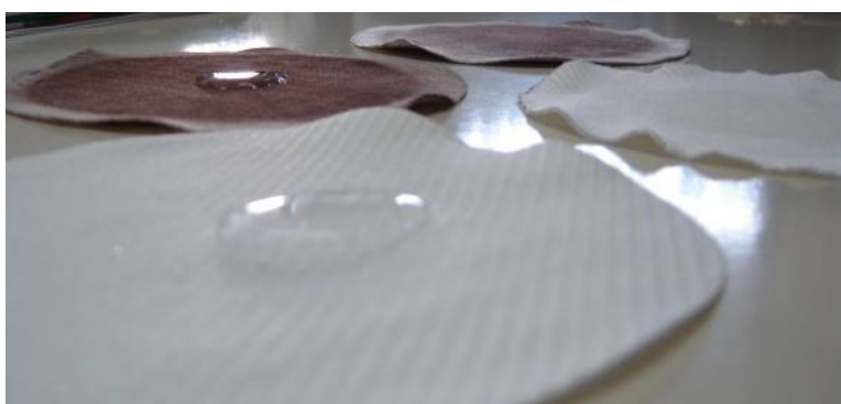
Figura 5.76 – Efeito de repelência e impermeabilização do tecido filtrante, após coating de PTFE, antes e após a realização de ensaios de filtração.
