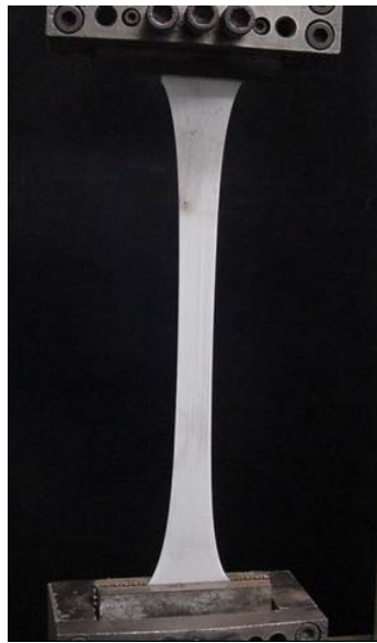
Figura 4.8 – Ensaio de tração e alongamento na ruptura no tecido filtrante
