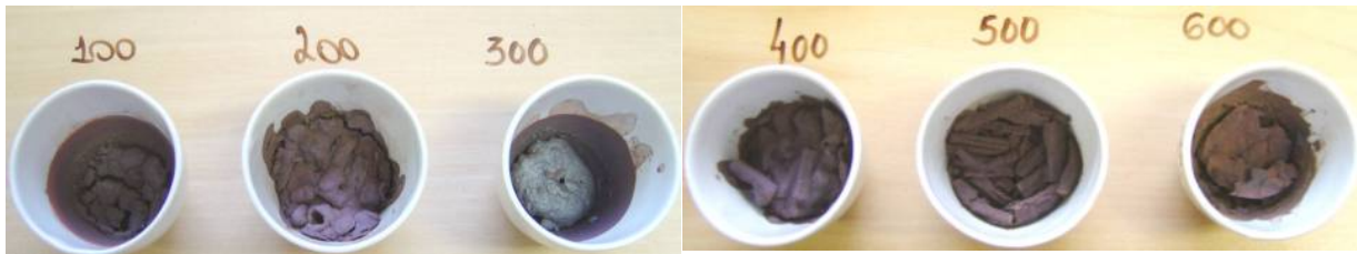
Figura 5.22 – Foto dos resíduos de um tecido filtrante industrial após processo de calcinação
