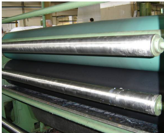
Figura 5.74 – Equipamento contendo cilindros “espremedores” utilizado para retirar o excesso de PTFE do tecido filtrante.
