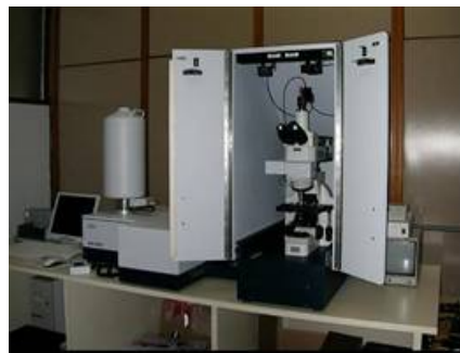
Figura 4.4 - Espectrômetro Raman Bruker RFS-100, dotado de detector de Germânio e acoplado a microscópio Nikon Eclipse E400.
