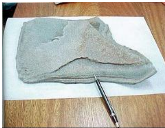
Figura 3.10 - Formação de incrustações de carbonato no sistema de vácuo da Samarco
