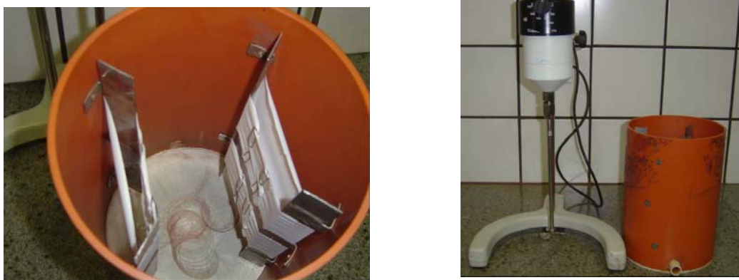
Figura 4.1 – Cuba e sistema de agitação utilizados na exposição do tecido filtrante
