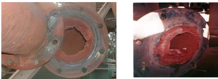
Figura 3.12 - Formação de incrustações nas tubulações de polpa da Samarco
