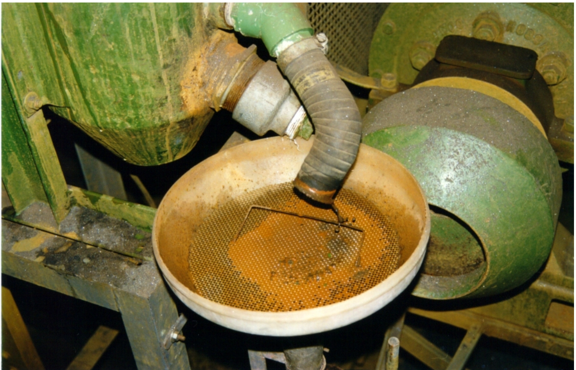
Figura 4.3 - Tela de proteção contra entupimentos da mangueira.
