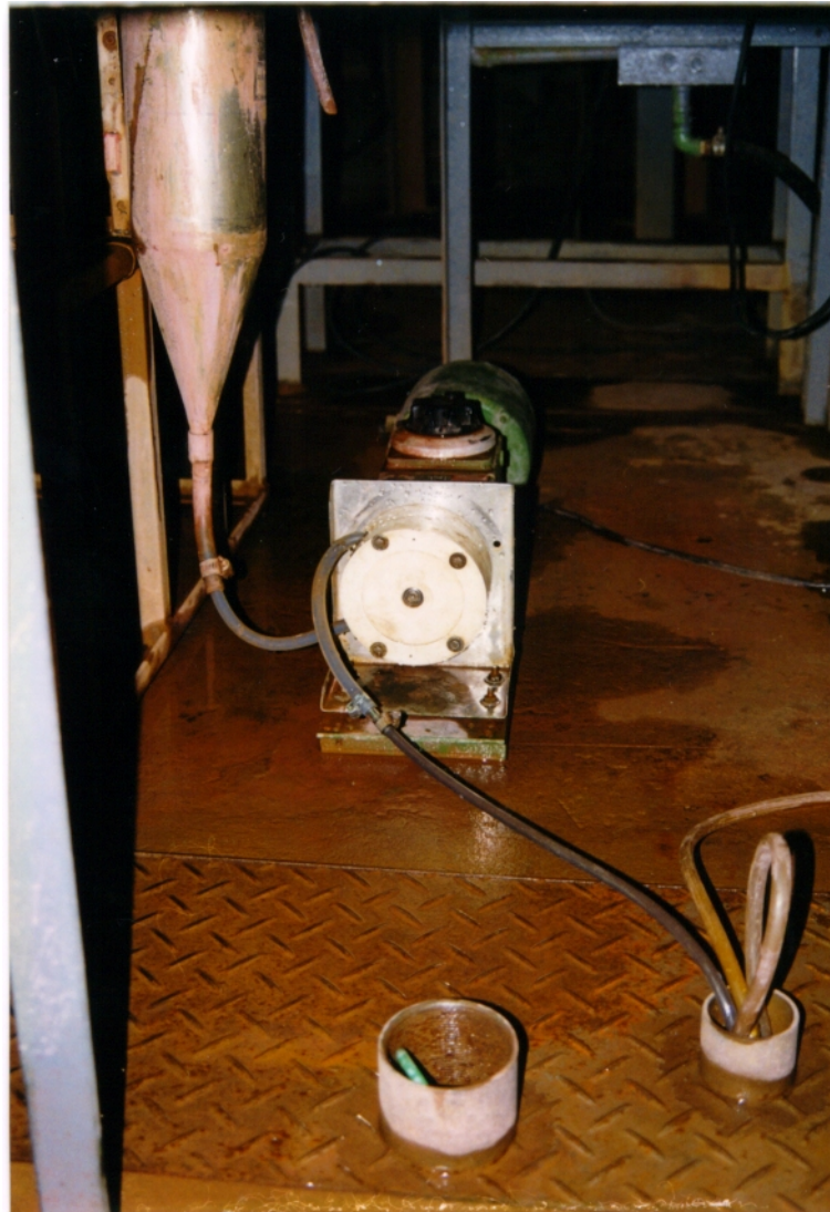
Figura 4.7 - Bomba peristáltica usada para bombear minério.
