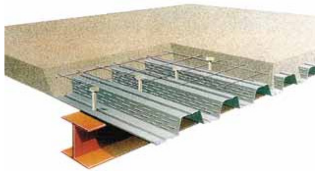
Figura 2.1 – Ilustração de uma estrutura mista
