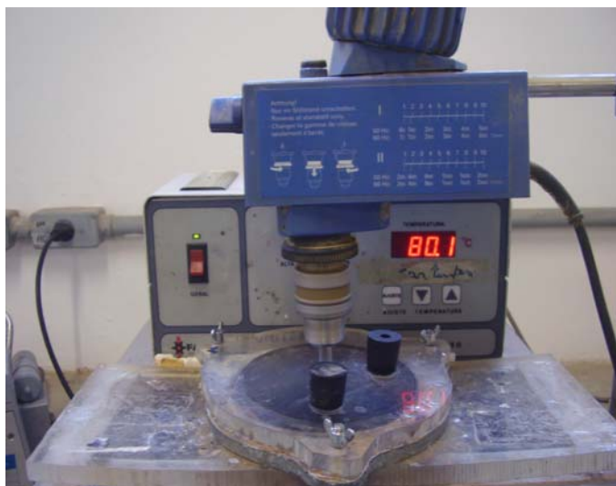
Figura 5.2 - Agitador mecânico utilizado para realização do estudo dos parâmetros ideais de lixiviação
