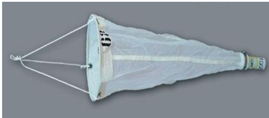
Figura 4.3: Rede de fitoplâncton de malha de 20 µm.
