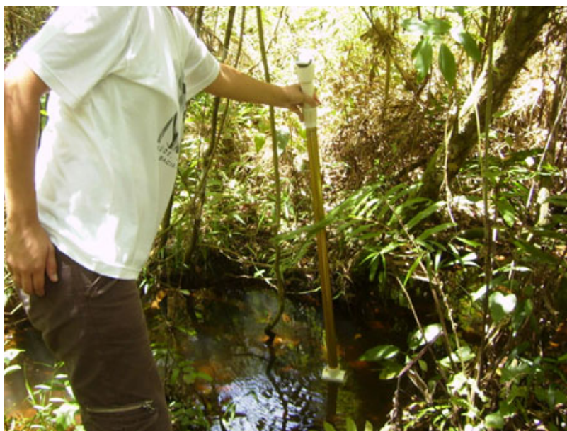
Figura 4.3 - Utilização do micromolinete em campo para a determinação da velocidade da água.
