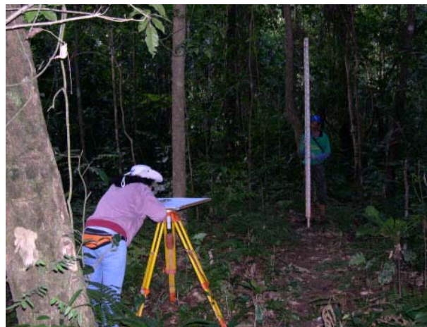
Figura 3.1- a) Conjunto prancheta e alidade. b) Posicionamento da régua sobre o ponto de interesse e visada do ponto a partir da referência.
