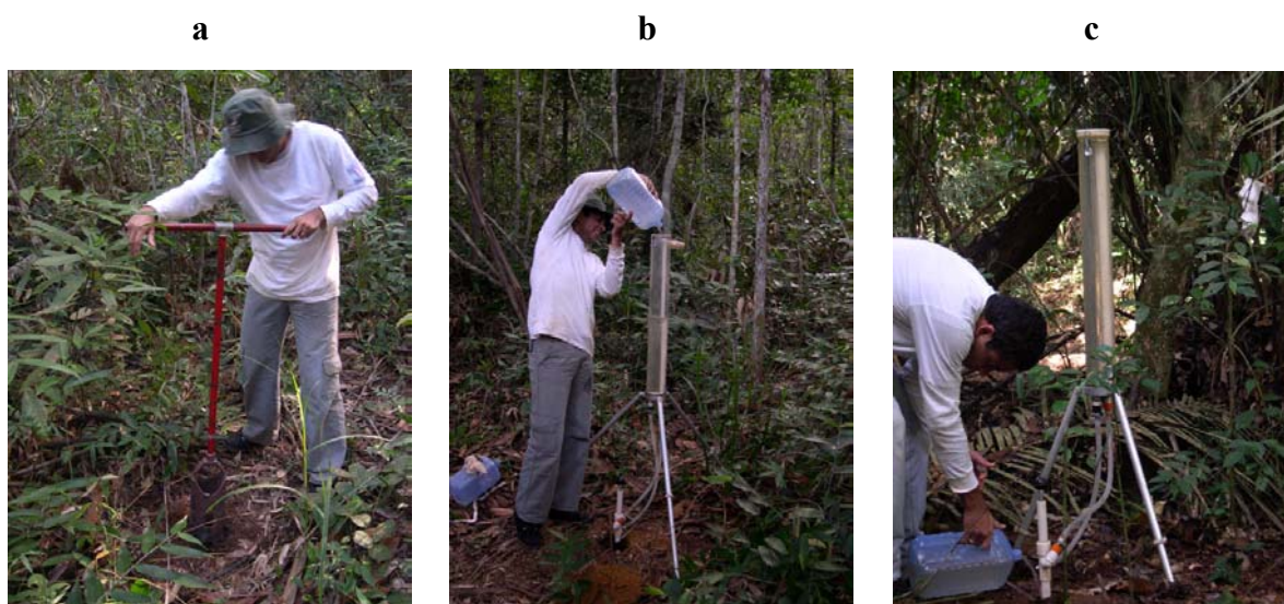
Figura 4.3- a) Poço sendo aberto com o trado; b) Permeâmetro já posicionado no poço e seu reservatório sendo completado com água; c) Poço sendo preenchido com água.
