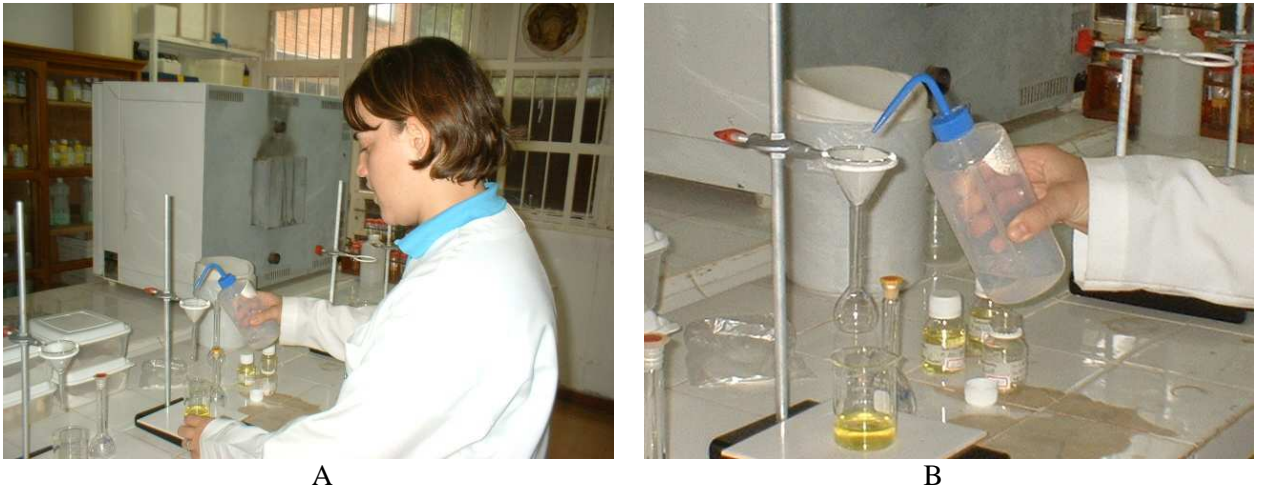
Figura 4.7 – Foto A digestão das amostras de sedimento e Foto B detalhe da filtragem do sedimento usando filtro de papel.
