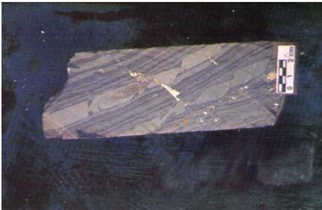
Foto 17 - Metarritimito com microfalhas deformando as laminações. F378/CT 201,50m
