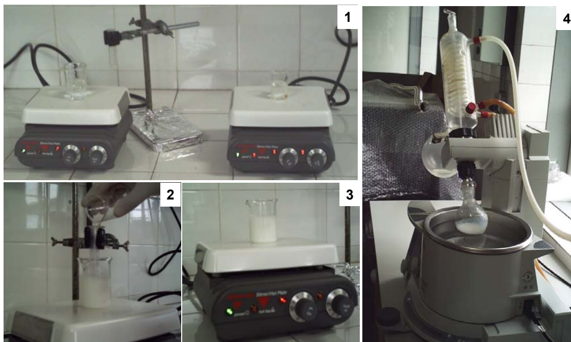
FIGURA 14: Etapas da Preparação de Nanocápsulas e Nanoemulsões. 1) Preparação das fases aquosa e oleosa; 2) Preparação das nanocápsulas e nanoemulsões; 3) Agitação após preparação; 4) evaporação do solvente.
