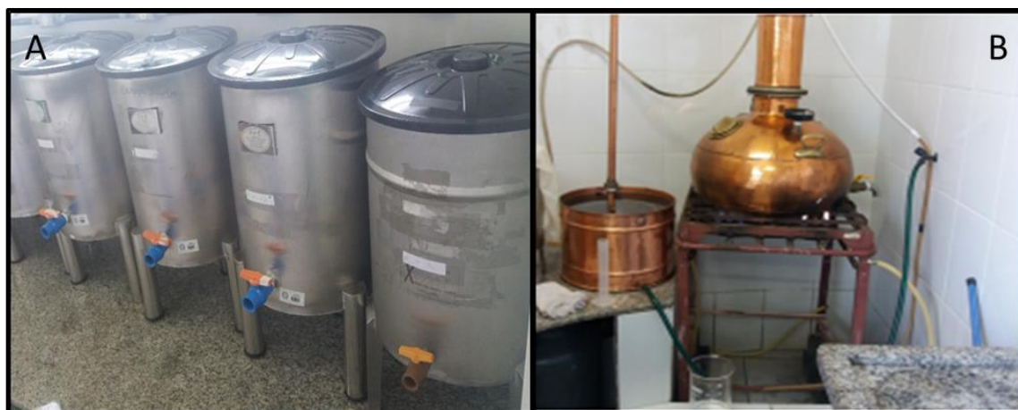
Figura 2: (A) dornas de fermentação de alumínio utilizadas na produção piloto, (B) destilador de cobre usado na produção da cachaça
