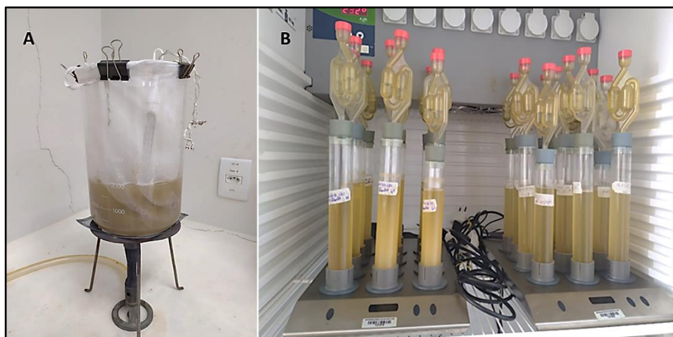
Figura 4: (A) produção do mosto cervejeiro em escala laboratorial pelo método BIAB, (B) fermentadores utilizados para realização do experimento em escala laboratorial.
