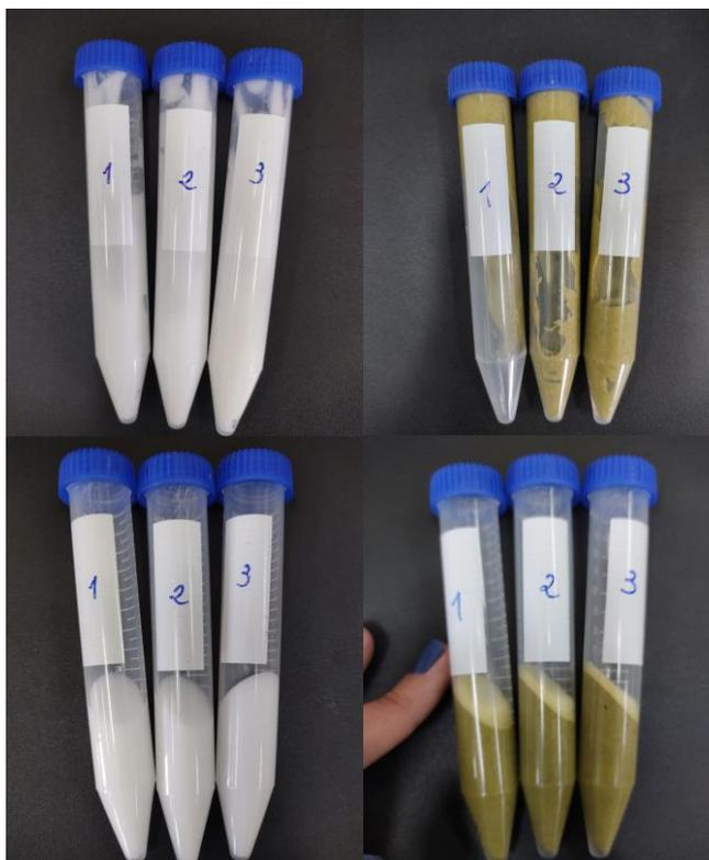
**Figura 12** Amostras de formulação branca e com associação dos EEB antes e após a centrifugação
