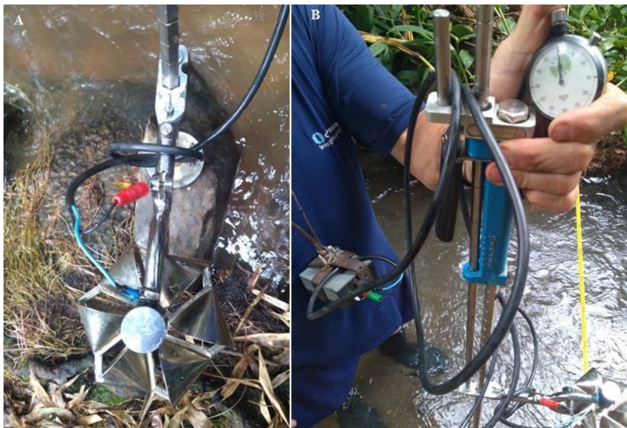
Figura 4.3: A: Molinete de eixo vertical e B: cronômetro, haste graduada e emissor de som.
