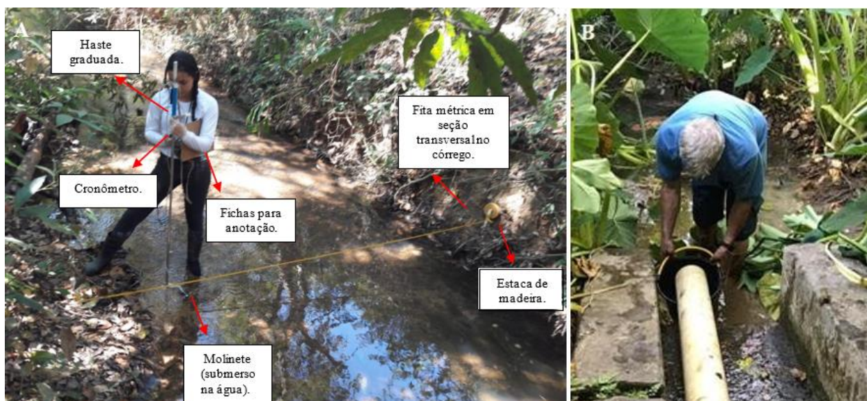
Figura 4.4 : Materiais utilizados nas medições de vazão, em A: medição com molinete, e em B: medição pelo método volumétrico.
