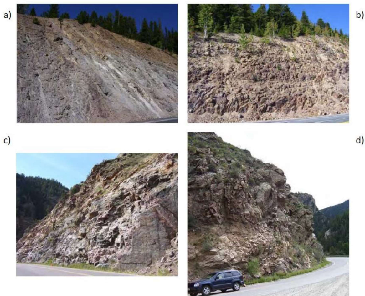
Figura 2.10 – Feições de lançamento, onde: a) Nenhuma; b) Menor; c) Maiores; d) Extremas (modificado de Russel et al., 2008).
