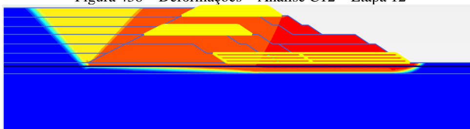
Figura 439 – Zona de plastificação – Análise C12 – Etapa 12
