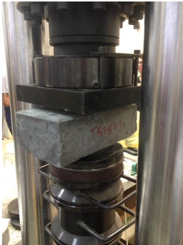
Figura 4.1 - Ensaio de resistência à compressão.
