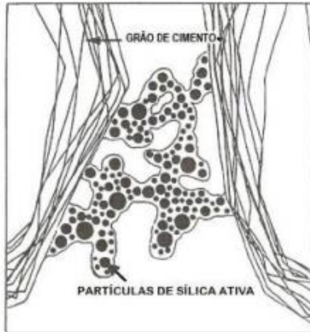
Figura 2.18 - Mecanismos de redução da exsudação na pasta de cimento pela adição de sílica ativa (Resende, 2013).
