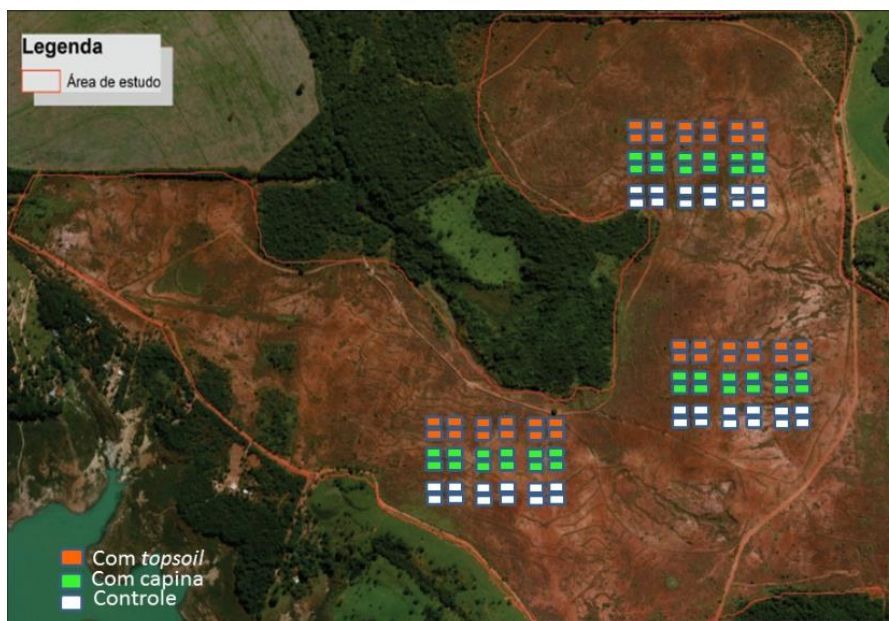
Figura 3: Imagem de satélite da área de empréstimo onde foram instalados os experimentos mostrando o esquema com os 3 tratamentos, cada cor destacando as 12 parcelas por tratamento. O fragmento florestal no centro da imagem é utilizado como área de referência de onde foi retirado o topsoil .
