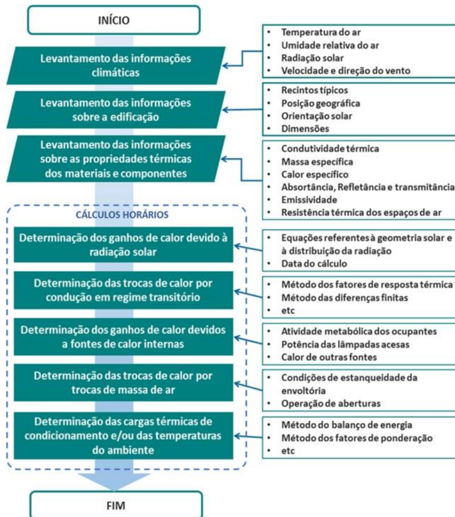
Figure 28 - Principais características de programas de simulação computacional Fonte: Adaptado de AKUTSU, 1998.
