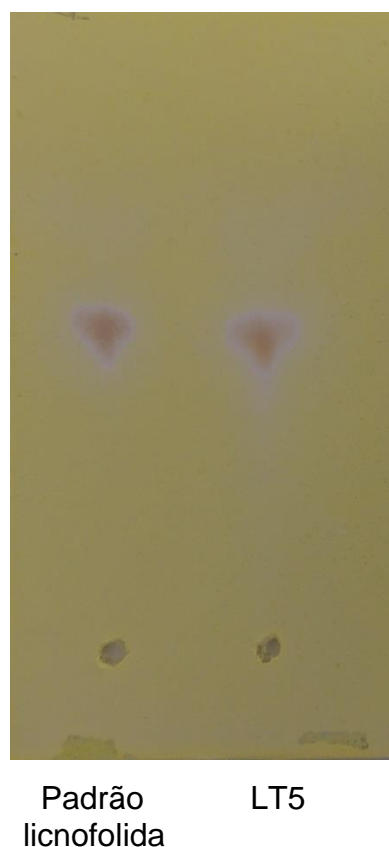
Figura 5. CCD do padrão de licnofolida e de LT5 utilizando como eluente \text{CHCl}_3 :AcOEt (50:50) e revelada com sulfato cérico.
