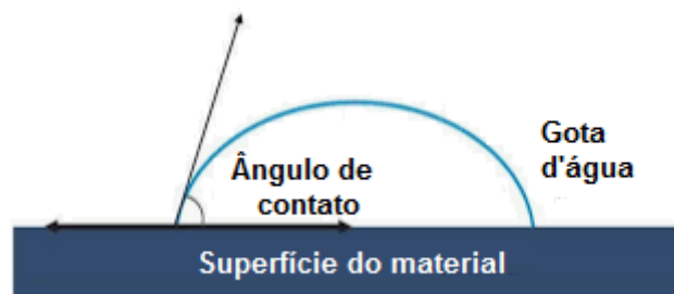
Figura 20 – Esquema do ângulo de contato. Adaptado de Yang et al. (2020).
