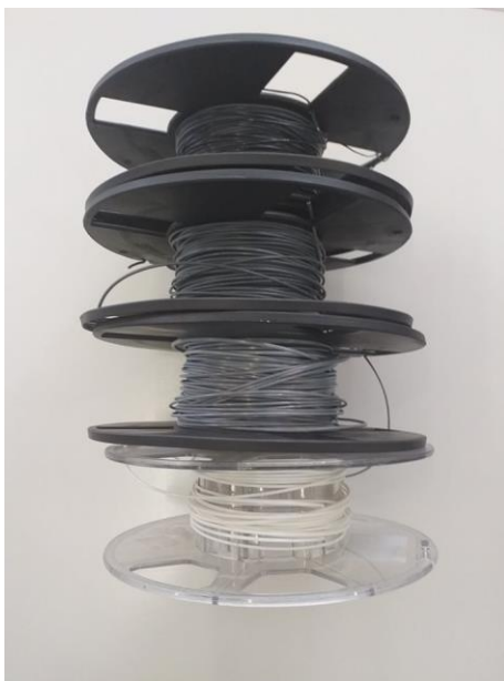
Figura 19 – Filamentos com diferentes teores de EG (de baixo para cima: PLA / PEG, PLA / EG1%, PLA / EG 3% e PLA / EG5%).
