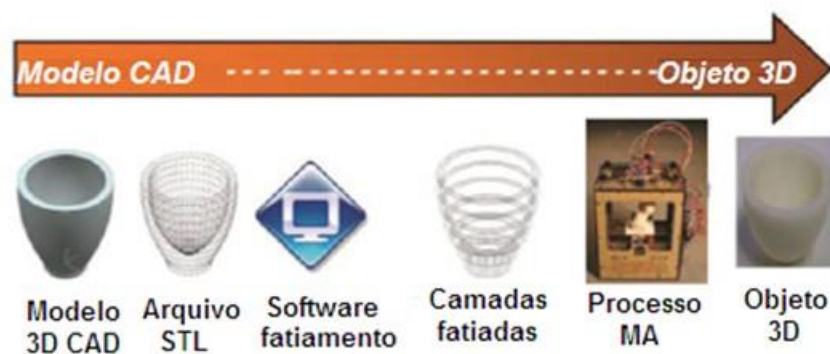
Figura 8: Esquema geral para manufatura aditiva (MA) (ELMARAGHY & ELMARAGHY, 2014)
