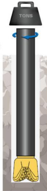
Figura 3.9 - Figura esquemática de perfuração rotativa por esmagamento.
