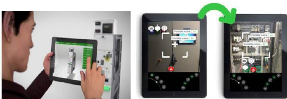
Figura 1-2: Realidade Aumentada aplicada ao contexto de manutenção elétrica. Fontes: https://www.mtitecnologia.com.br e https://se.com , respectivamente.
