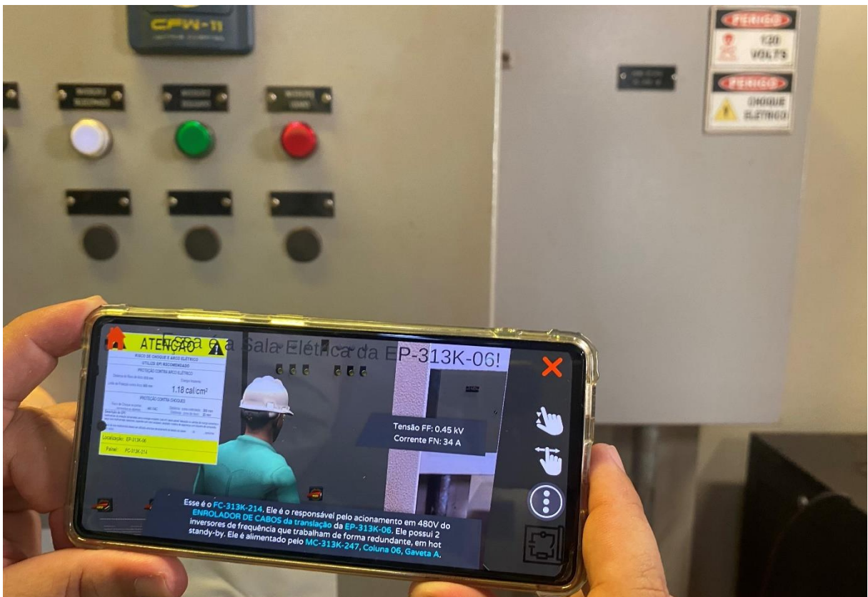
Figura 4-14: Sobreposição dos objetos em RA ao ambiente real, após a leitura do TAG 06. Fonte: Autor.
