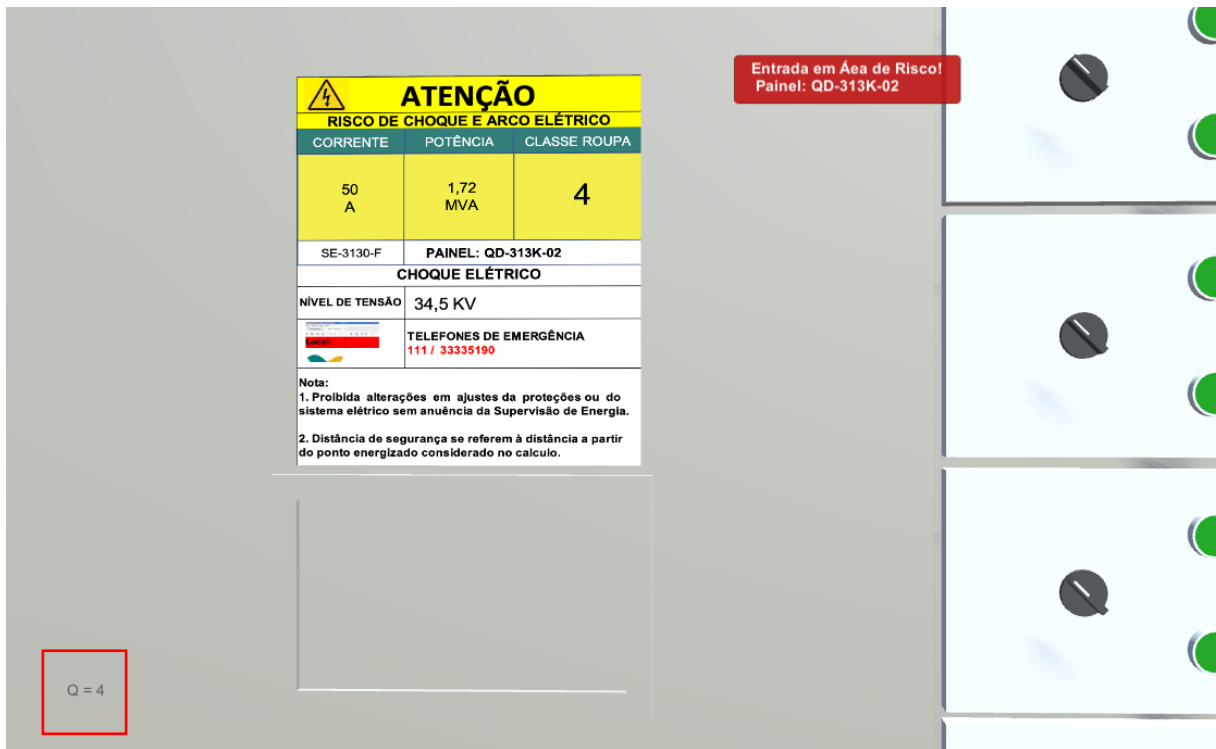
Figura 3-6: Imagem com a tag de aviso de entrada na área de risco e indicação do painel. Em destaque dentro do quadrado vermelho sem preenchimento encontra-se a contabilização dos erros cometidos pelo usuário no momento da aplicação dos testes.
