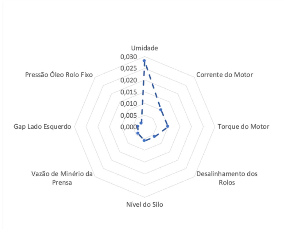
Figura 18: Classificação das variáveis mais significativas para o resultado específico da prensa de rolos. Fonte: O autor.
