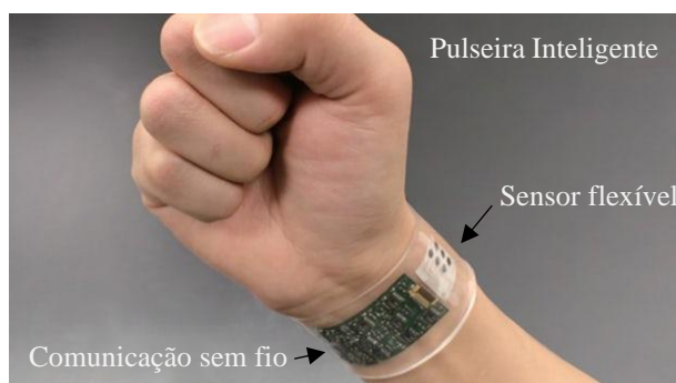
Figura 1: Sensor vestível, do tipo pulseira flexível, que realiza a análise de dados químicos contidos no suor e monitora também a temperatura do usuário, enviando os dados em tempo real via rede sem fio.
