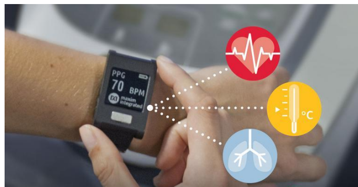
Figura 6: Exemplo de dispositivo vestível com monitoramento de batimentos cardíacos, temperatura e oxigenação no sangue
