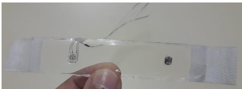
Figura 28: Pulseira de PDMS com LEDs e LDR.
