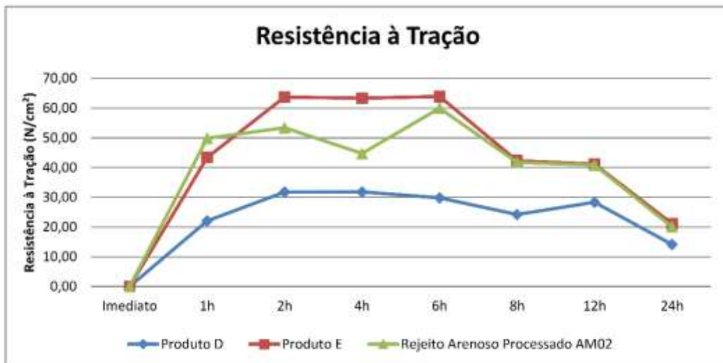
Figura 5.21- Comparativo da resistência à tração em função do tempo dos produtos D e E, e do rejeito arenoso processado AM02.
