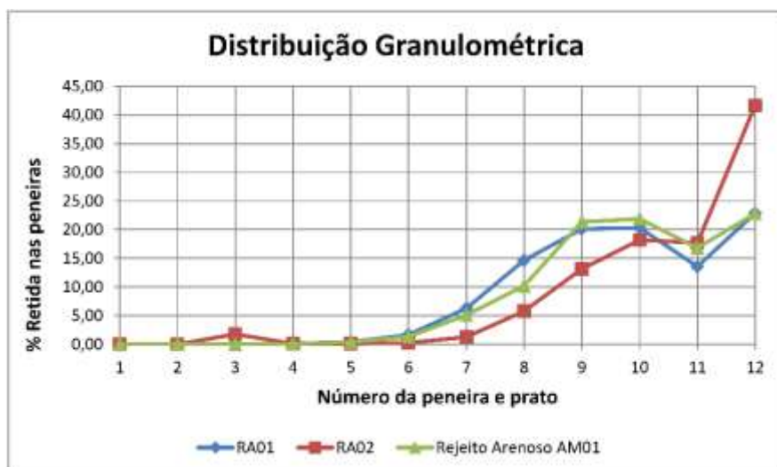
Figura 5.6- Comparativo da distribuição granulométrica das amostras de rejeito arenoso natural RA01 e RA02, e da amostra de rejeito arenoso (AM01).
