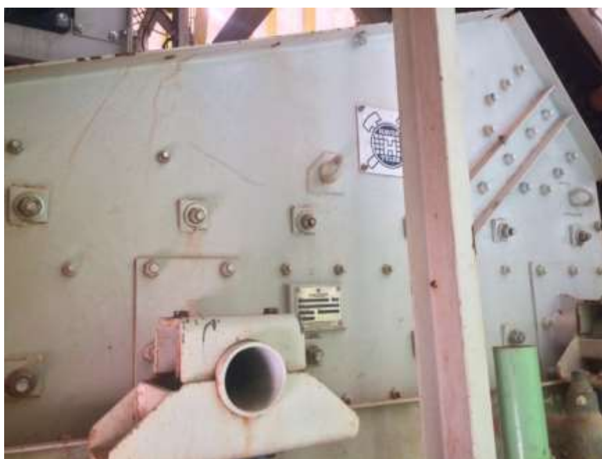
Figura 4.6- Peneira vibratória horizontal modelo UMD800x1500 fabricada pela empresa Haver & Boecker.
