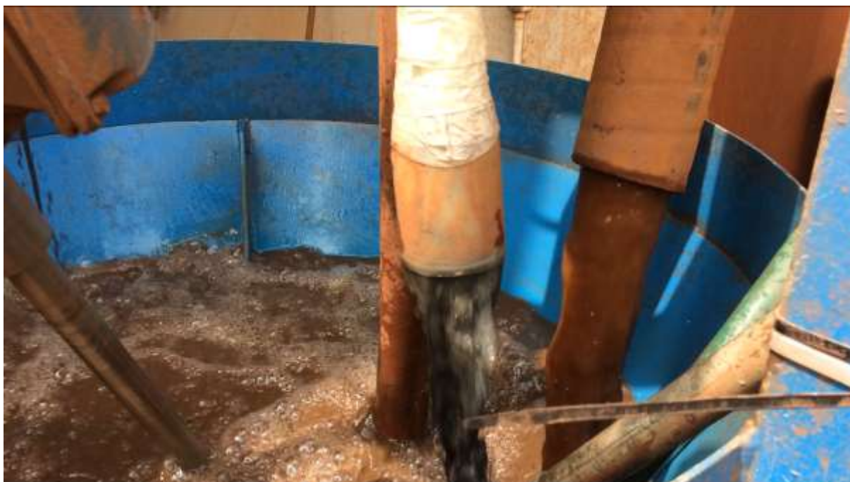
Figura 5.7- Saídas de underflow e overflow do conjunto de hidrociclonação piloto modelo LBCBHL durante o ensaio de deslamagem e desaguamento do rejeito arenoso RA01.
