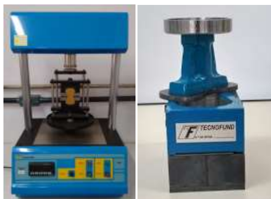
Figura 4.8- Máquina universal para resistência de areia com o acessório para o ensaio de resistência a tração e caixa de macho para confecção dos corpos de prova.
