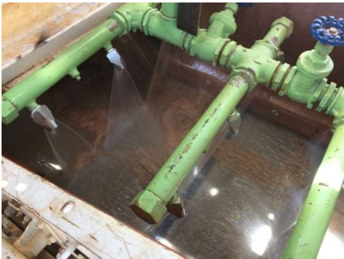
Figura 5.8- Visão superior da peneira vibratória durante a classificação do rejeito arenoso RA02.
