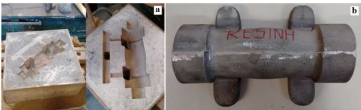
Figura 3.7- (a) Imagem do molde de areia fabricado com areia fina pelo processo resina de cura a frio. (b) Vista frontal da peça de alumínio obtida pelo molde de areia fina pelo processo de cura a frio (OLIVEIRA, 2016).
