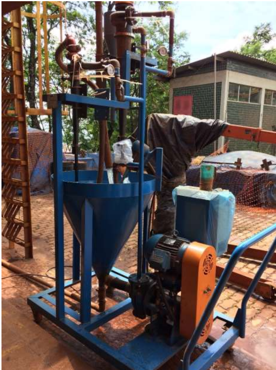
Figura 4.5- Conjunto de hidrociclonagem piloto modelo LBCBHL da marca FLSmidth Krebs.
