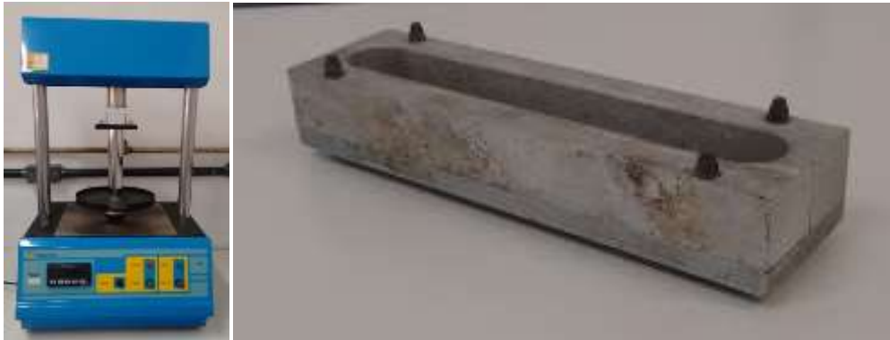
Figura 4.9- Máquina universal para resistência de areia com o acessório para o ensaio de resistência à flexão e caixa de macho para confecção dos corpos de prova.
