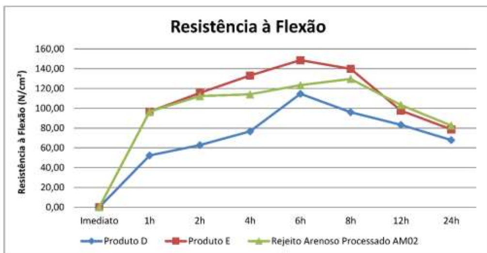
Figura 5.22- Comparativo da resistência à flexão em função do tempo dos produtos D e E, e do rejeito arenoso processado AM02.
