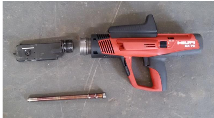
Figura 35: Ferramenta para fixação dos conectores Hilti X-HVB
