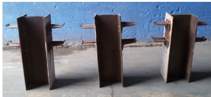
Figura 52: Perfis dispostos com a indicação da corrosão superficial nos conectores Hilti X-HVB
