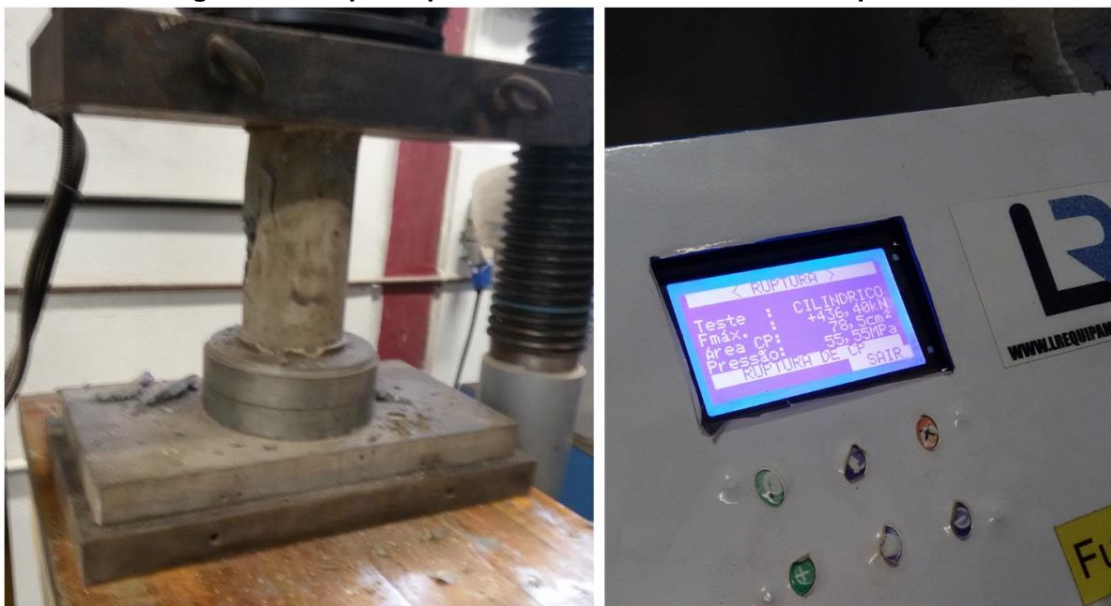
Figura 87: Corpo de prova cilíndrico 1 - ensaio de compressão
