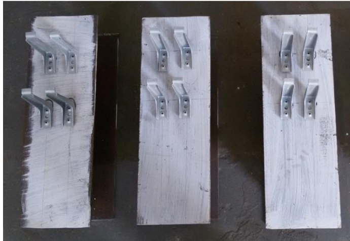
Figura 39: Perfis laminados com os conectores Hilti X-HVB posicionados para fixação
