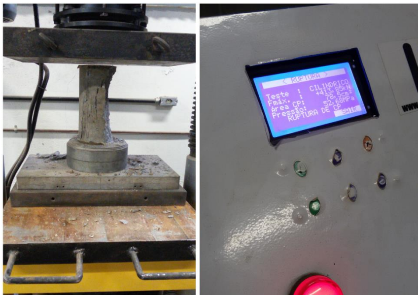
Figura 89: Corpo de prova cilíndrico 3 - ensaio de compressão
