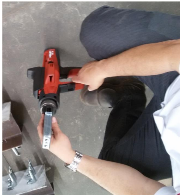
Figura 42: Conector Hilti X-HVB posicionado na ferramenta.
