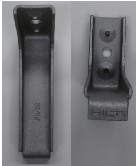
Figura 45: Conectores Hilti X-HVB após jateamento
