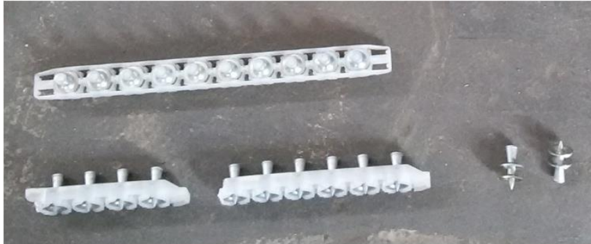
Figura 37: Pinos para fixação dos conectores Hilti X-HVB
