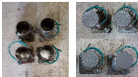
Figura 70: Molde e corpos de prova cilíndricos preenchido com concreto
