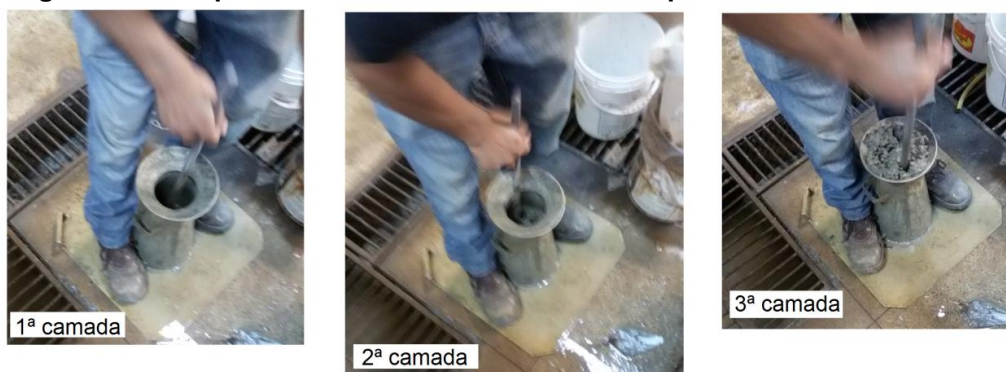
Figura 65: A sequência de enchimento de concreto para o ensaio de abatimento
