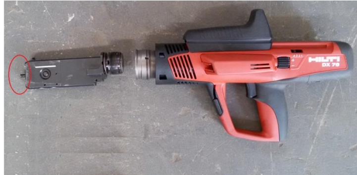
Figura 41: Saliência existente na ferramenta servindo de guia para o conector Hilti X-HVB
