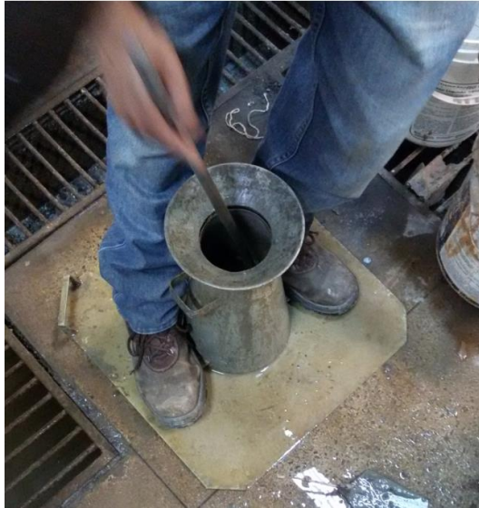
Figura 64: Conjunto e a base metálica umedecida.
