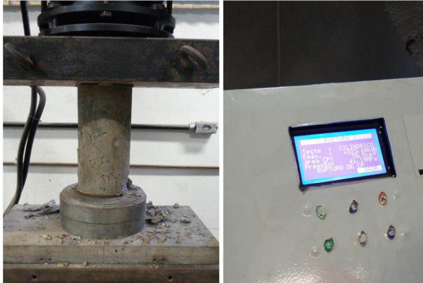
Figura 88: Corpo de prova cilíndrico 2 - ensaio de compressão
