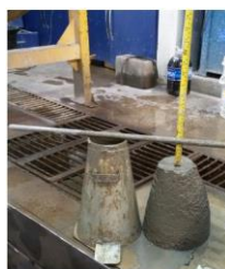
Figura 68: Medição do abatimento
