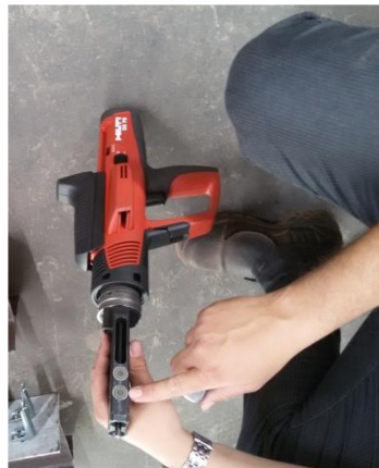
Figura 40: Ferramenta para fixação dos conectores Hilti X-HVB
