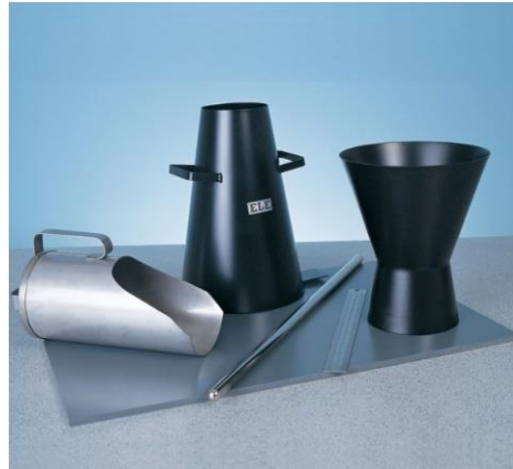
Figura 62: Equipamentos para o Slump test
