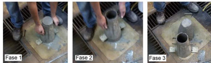
Figura 67: Retirada do molde para a realização do ensaio de abatimento
