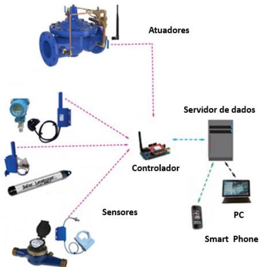
Figura 9: fluxograma de informações entre os diferentes componentes: sensores, atuadores, controlador, servidor de dados e dispositivos de interface
