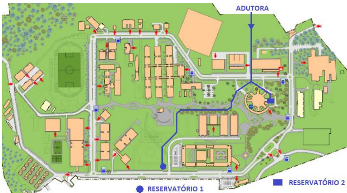
Figura 20: Chegada de água pela adutora até os dois reservatórios de distribuição do campus.
