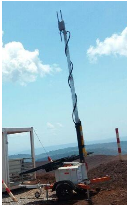
Figura 7: Trailer móvel com rádio em S11D.
