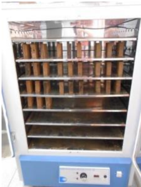
Figura 4-6: Estufa onde as amostras foram secas. Laboratório Pedologia e Análise Ambiental - CODAGEO, IFMG - Campus Ouro Preto. Fonte: arquivo pessoal.
