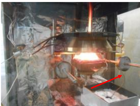
Figura 4-14: Detalhe do termopar posicionado na superfície da amostra, durante a ignição. Fonte: arquivo pessoal.
