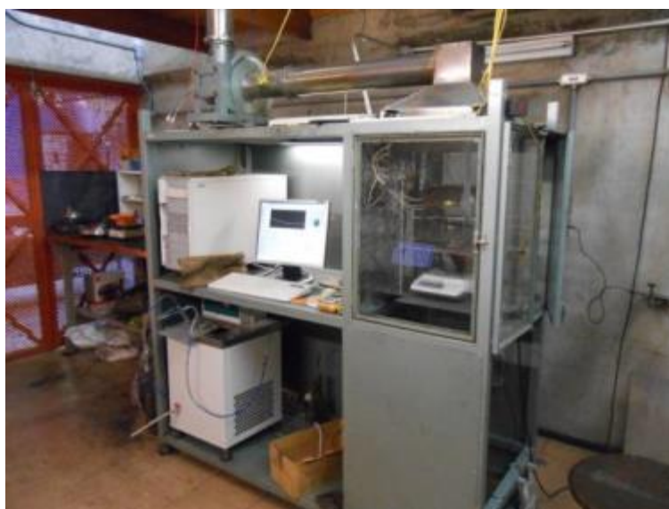
Figura 4-10: Bancada com o calorímetro cônico, instalada no laboratório de ensaios de combustão do INPE/LCP. Fonte: arquivo pessoal.
