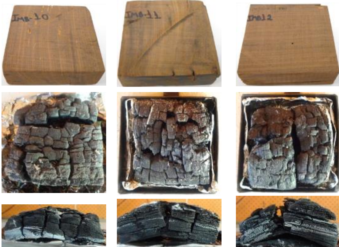
Figura 5-15: Aspecto das madeiras tratadas com solução aquosa de permetrina a 10%, antes e depois do ensaio. Fonte: arquivo pessoal.
