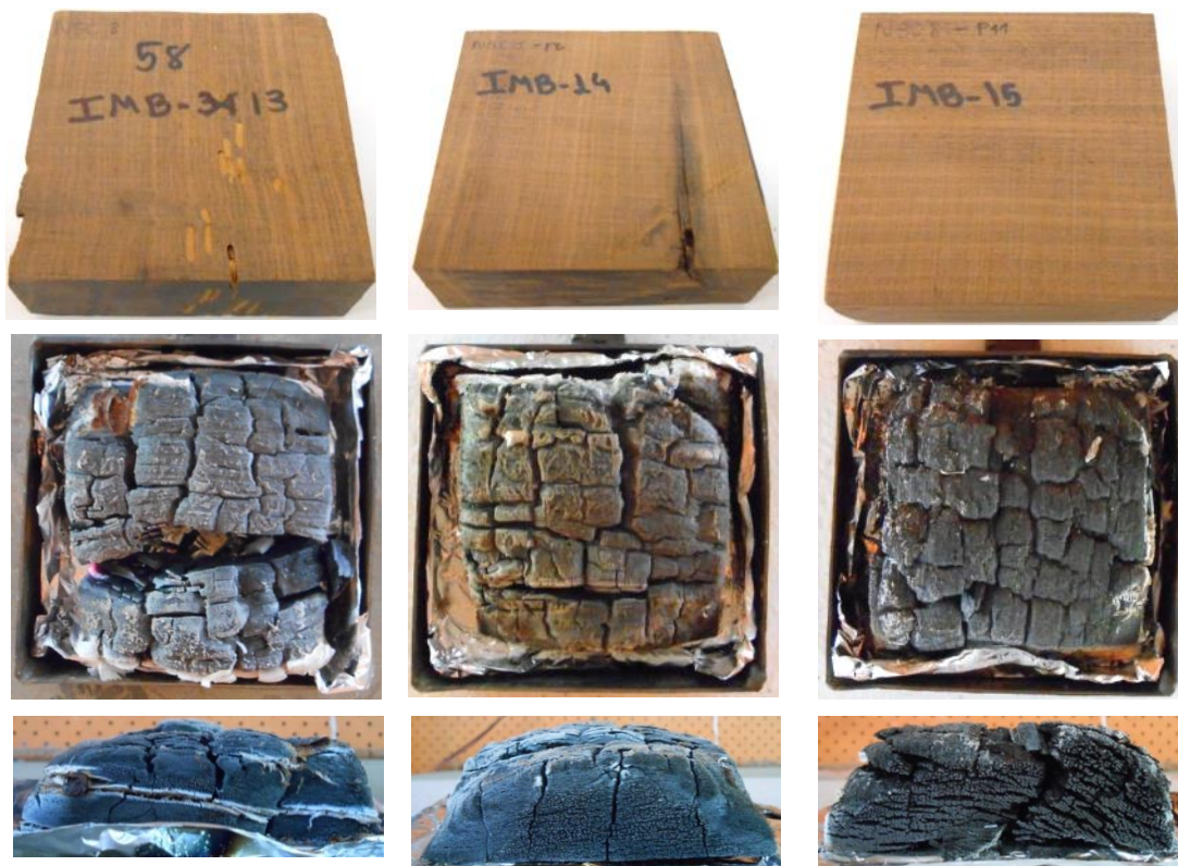
Figura 5-20: Aspecto das madeiras, tratadas com solução de permetrina com querosene a 1%, antes e depois do ensaio. Fonte: arquivo pessoal.
