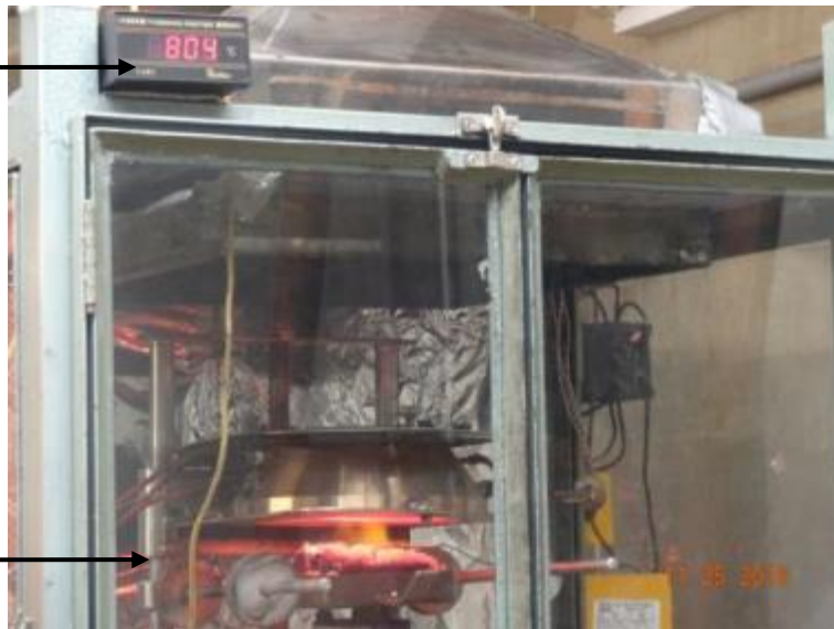
Figura 4-21: Detalhe do leitor de temperatura da superfície no momento da ignição, e a mostra em chamas. A temperatura mostrada é após a ignição. Fonte: arquivo pessoal.
