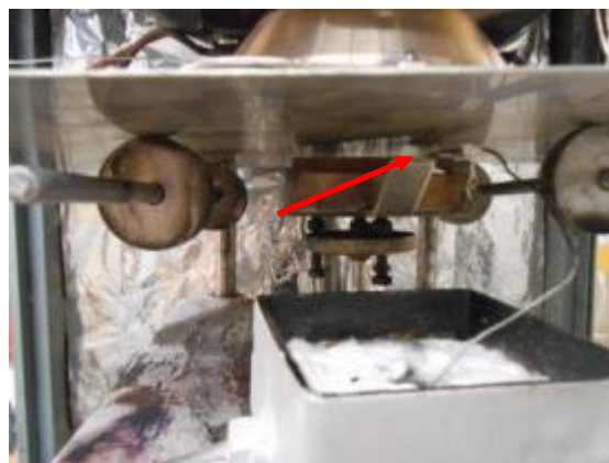
Figura 4-15: Detalhe do termopar posicionado na superfície da amostra. Fonte: arquivo pessoal.
