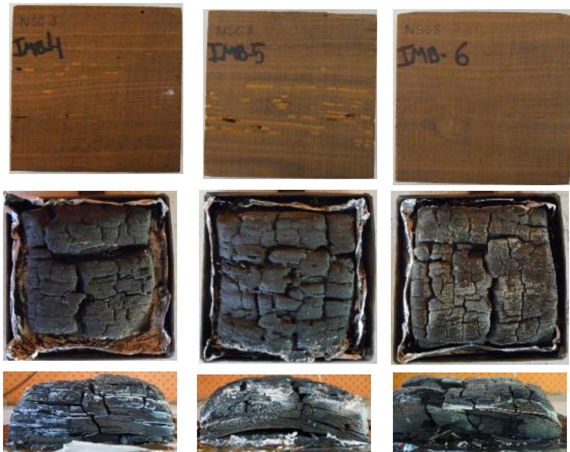
Figura 5-11 : Aspecto das madeiras tratadas com solução aquosa de permetrina a 1%, antes e depois do ensaio. Fonte: arquivo pessoal.
