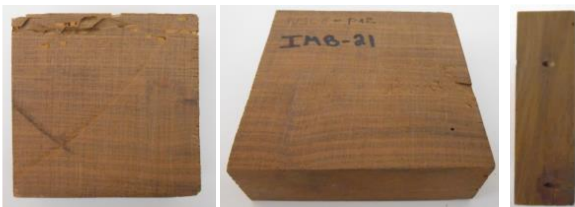
Figura 4-5: Corpo de prova, nas dimensões de 100mm x 100mm x 30mm, com a presença de furos e galerias provocadas por insetos xilófagos. Fonte: arquivo pessoal.
