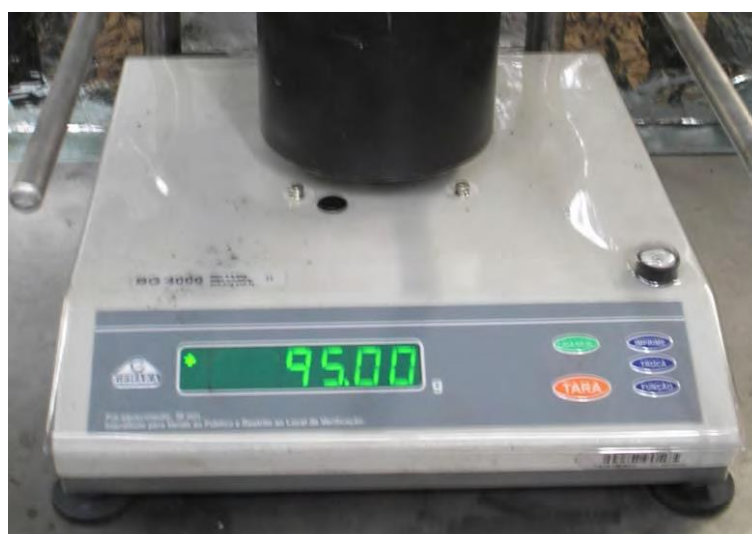
Figura 4-17: Balança Gehaka, modelo BG 4000. Fonte: GEMAQUE, 2012, p. 53.
