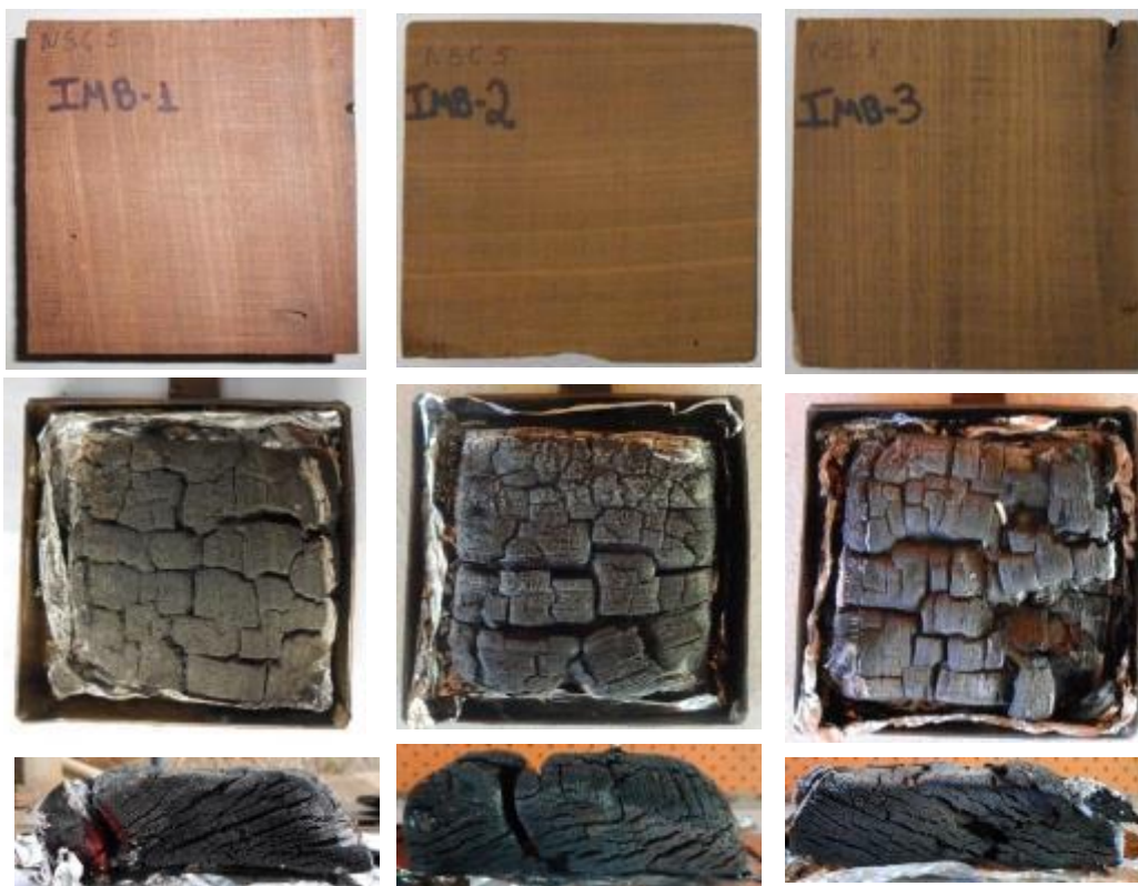
Figura 5-7: Aspecto das madeiras não tratadas, antes e depois do ensaio. Fonte: arquivo pessoal.
