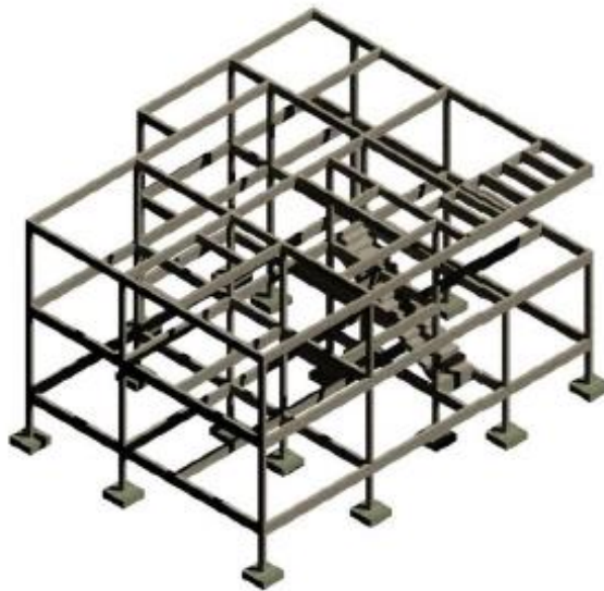
Figura 10: Projeto estrutural em concreto armado finalizado
