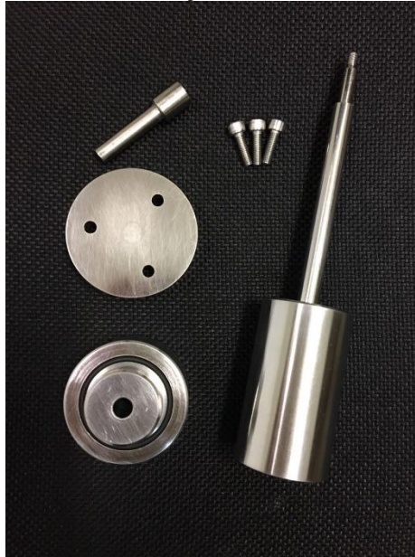
Figura 1.2: Aparelho utilizado na determinação da velocidade de dissolução intrínseca.
