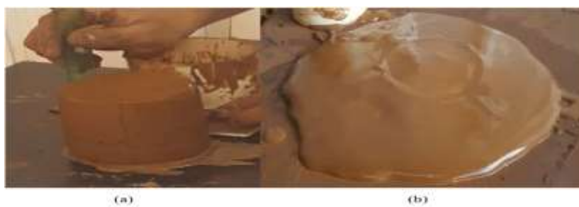
Figura 3.11 – (a) Ensaio de Slump com teor inicial de umidade da amostra. (b) Ensaio de Slump com teor final de umidade da amostra (Do autor, 2019).
