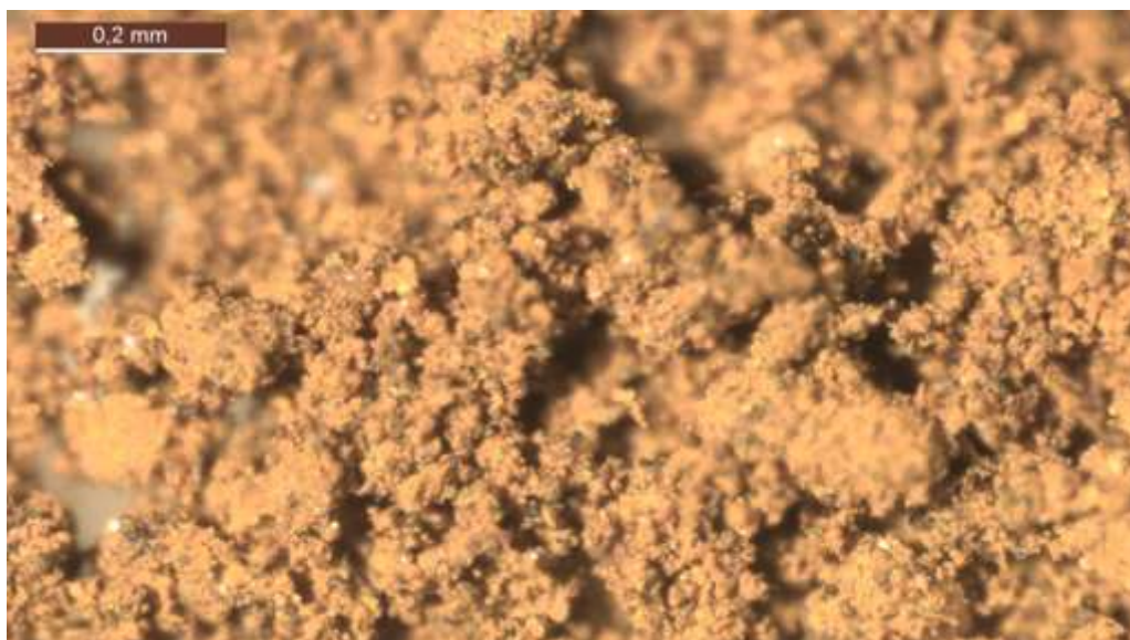
Figura 4.8 – Imagem ampliada em lupa eletrônica do rejeito ultrafino (Do autor, 2019).
