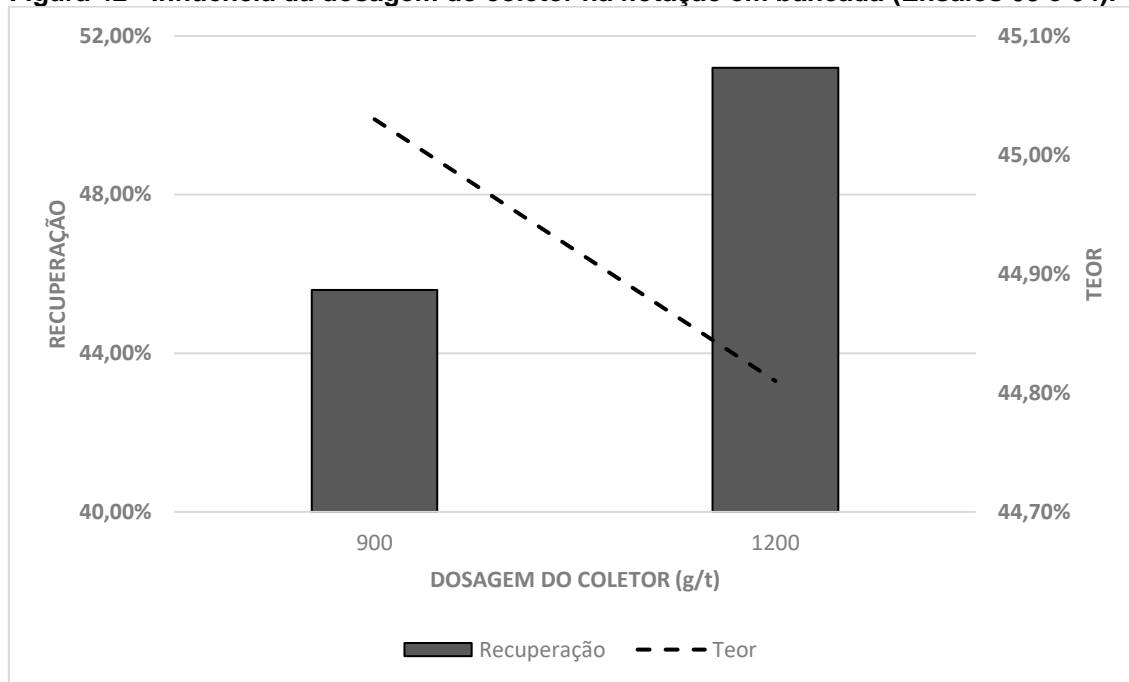
Figura 42 - Influência da dosagem do coletor na flotação em bancada (Ensaio 03 e 04).
