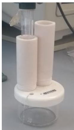
Figura 13. Célula eletroquímica contendo o eletrodo de trabalho e contra-eletrodo de platina.
