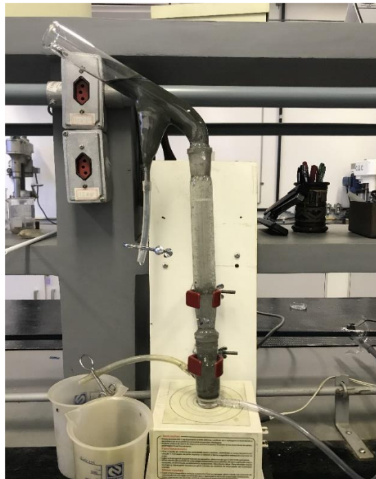
Figura 22 - Tubo de Hallimond utilizado nos ensaios de microflotação
