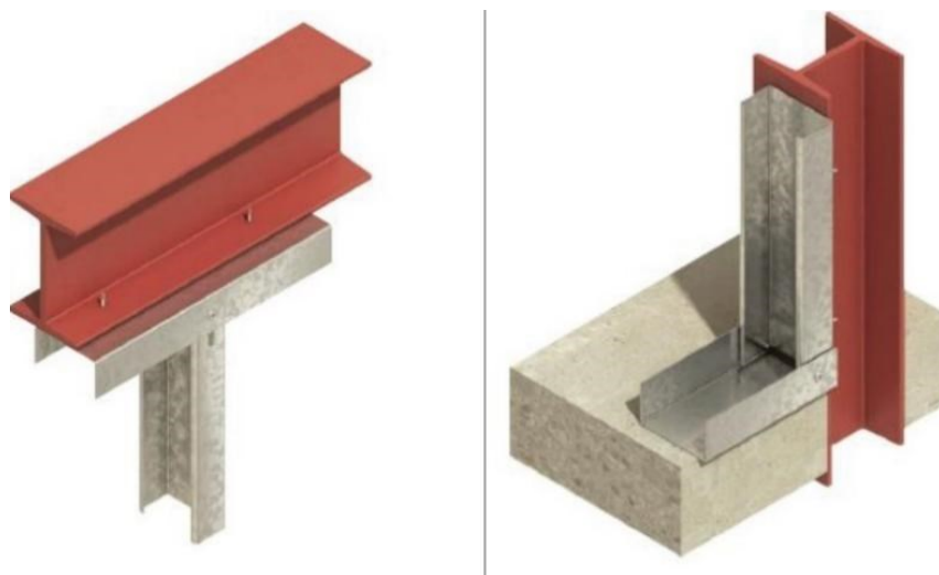
FIGURA 12 - Instalação de painéis embutidos para acabamento externo contínuo
