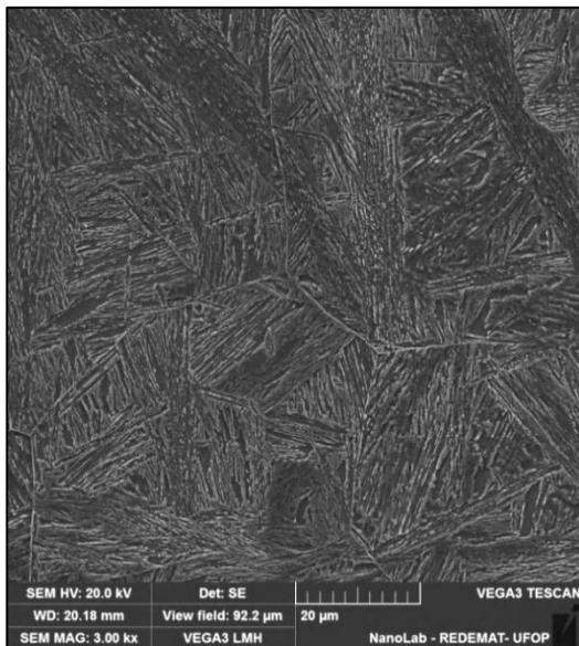
Figura 5.16: Micrografia de uma amostra resfriada a 25°C/s a partir da temperatura de austenitização de 1150°C. MEV. 3000x..
