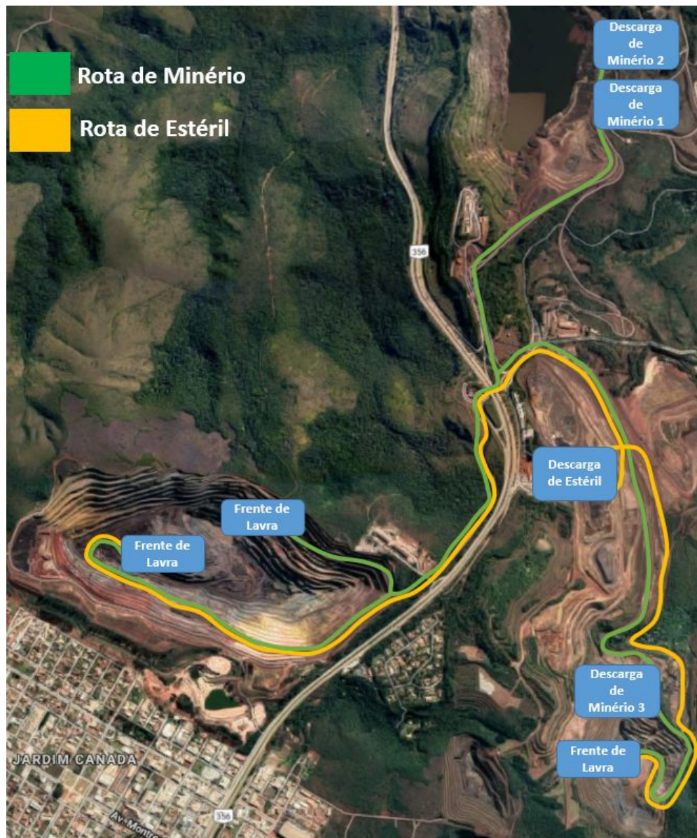
Figura 2.5: Exemplo de rotas de minério e estéril possíveis para os caminhões. (Imagem Retirada do Google Earth - Coordenadas: Lat= -20.050535^{\circ} , Lon= -43.976817^{\circ} )
